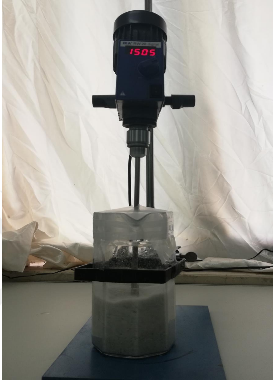
Şekil 4.8 Aşındırmalı yıkama deney düzeneği
