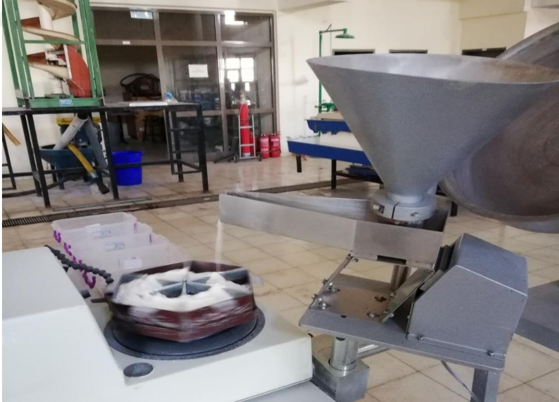
Şekil 4.7 Döner örnekleyici ile numune ayırma işlemi
