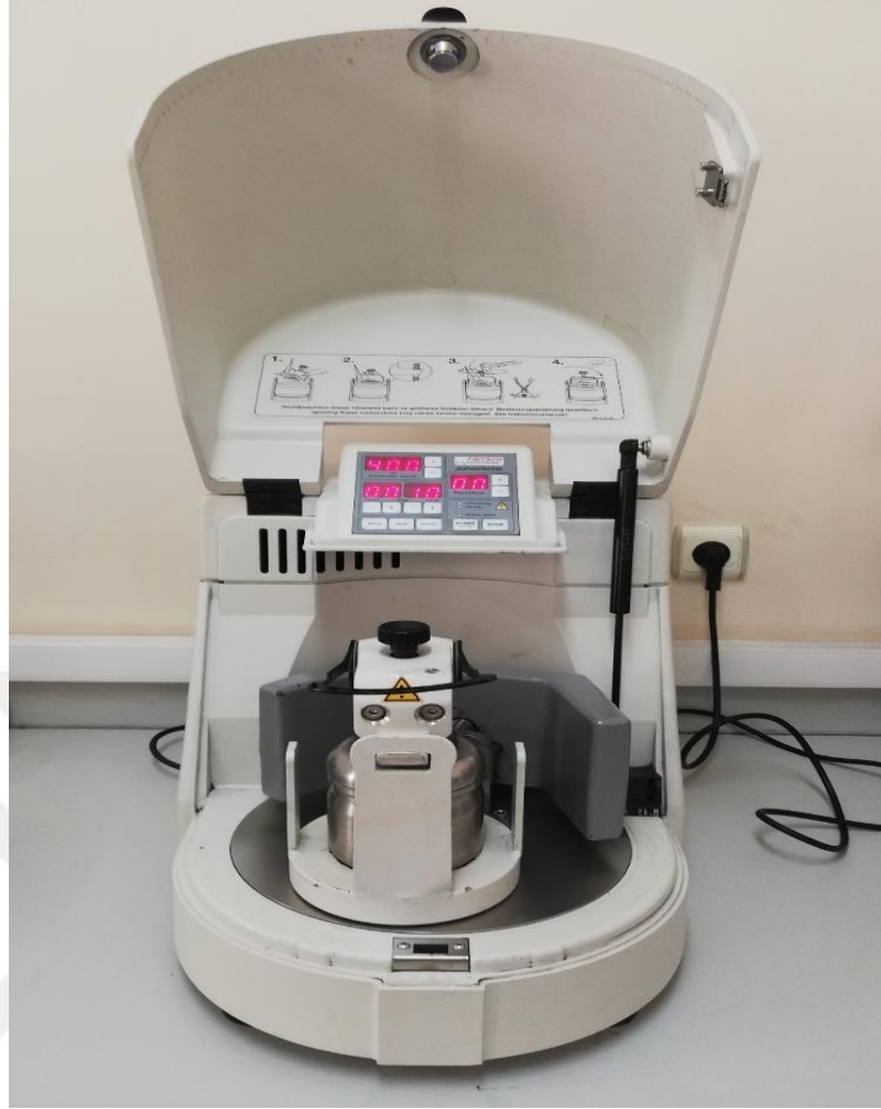
Şekil 4.10 Fritsch Pulverisette 6 Mono Mill model gezegensel bilyeli değirmen
