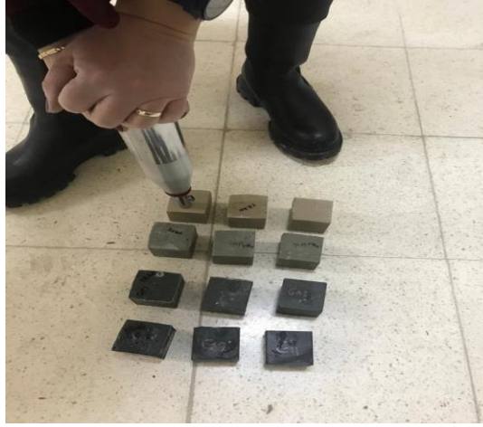
Şekil 3. 9: Schmidt çekici sertlik ölçümü
