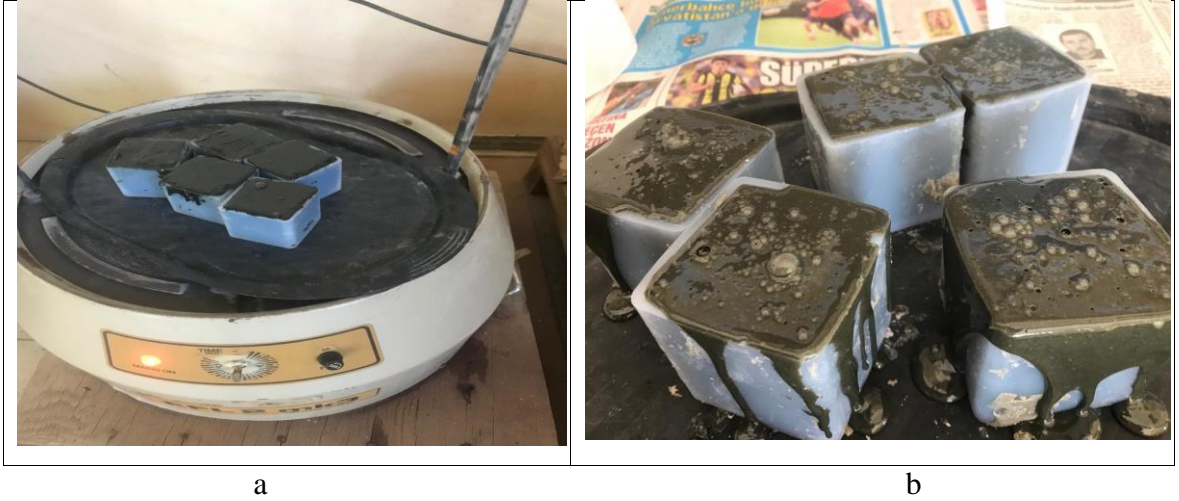
Şekil 3. 5: Suni mermer yapım aşaması a: titreşim sehпасı b: kalıplara aktarılan numuneler
