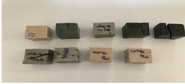
Şekil 4. 10: Termal şok deney döngüsünde kırılan numuneler
