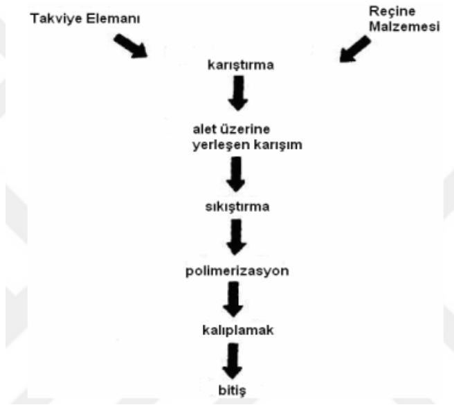
Şekil 2. 3: Kompozit malzeme üretim aşamaları (Gay ve diğ., 2003)
