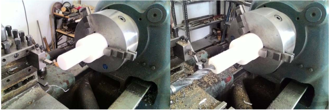
Şekil 3.50. Eksenel kuvvet milinin talaşlı imalatı
