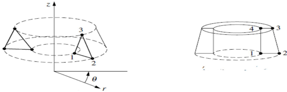
(d) Eksenel simetrik üçgensel ve dörtgensel elemanlar
