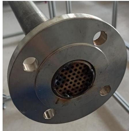
Şekil 4.4: Orifis plaka-Akım düzenleyici
