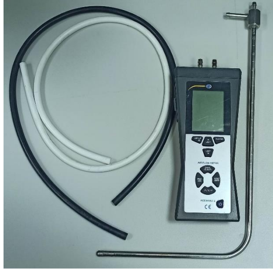
Şekil 4.6: Pitot tüpü ve anemometre
