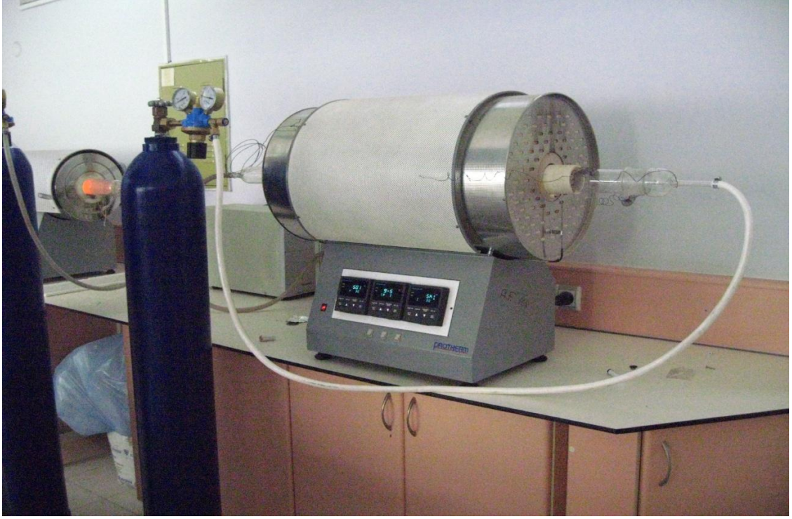
Şekil 4.1. Örneklerin ısıl işlemleri sırasında kullanılan PID kontrollü ve 3 bölge ısıtmalı \pm 1.0^{\circ}\text{C} kontrol hatasına sahip mikro işlemcili Protherm marka tüp fırın.
