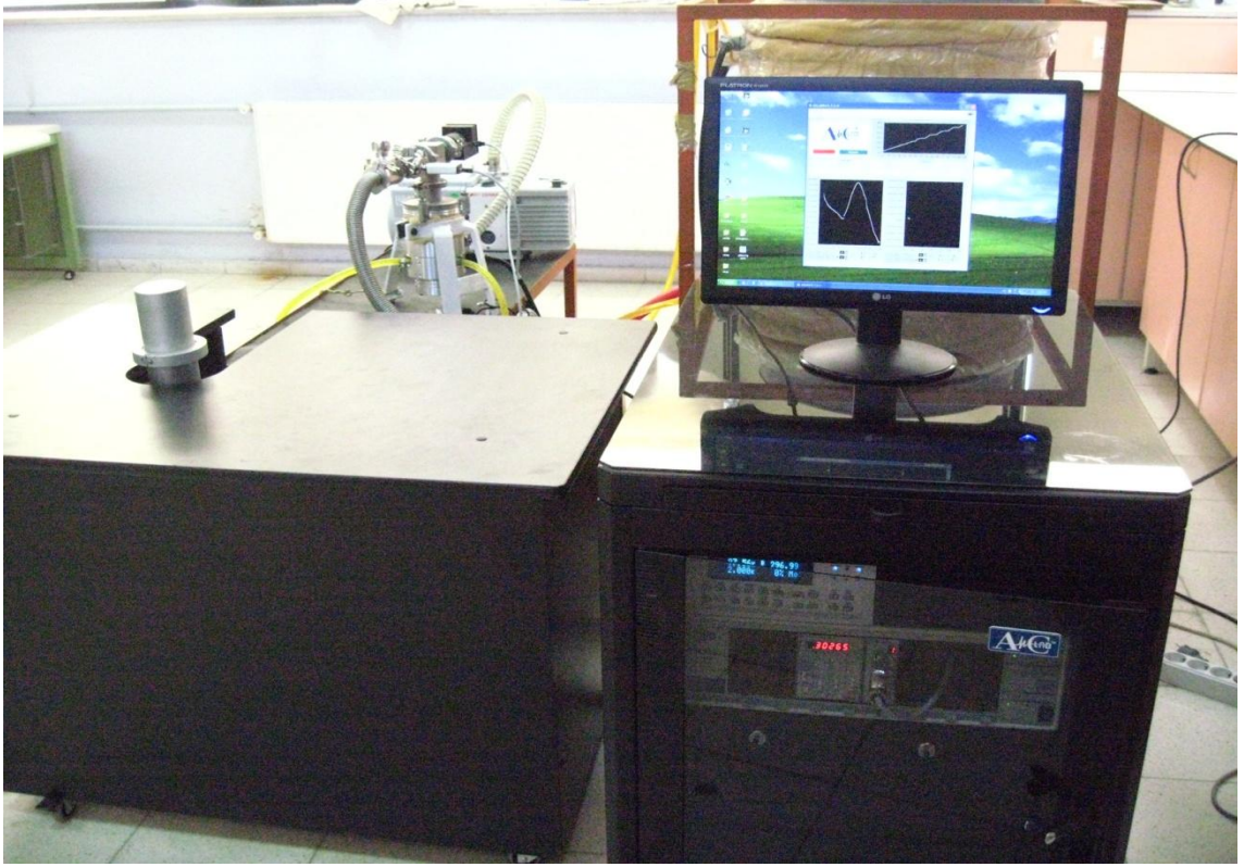
Şekil 4.6. Leybold LT-10 kapalı devre cryostat direnç ölçüm sistemi.
