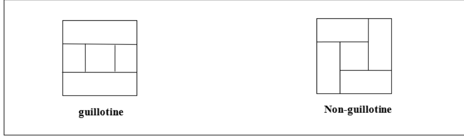
Şekil 3.4. Guillotine ve non-guillotine kesim örneği [38]
