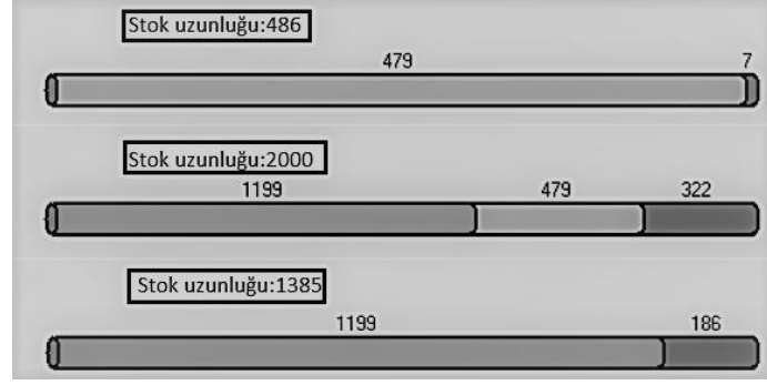
Şekil 3.2. 1 Boyutlu kesme stok problemi için çelik çubuk örneği [35]
