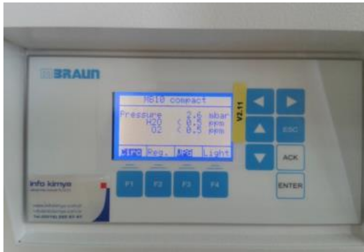
Şekil 2.9. Kullanılan glove-box sisteminin pil birleştirme işlemi sırasındaki oksijen ve nem seviyesi.
