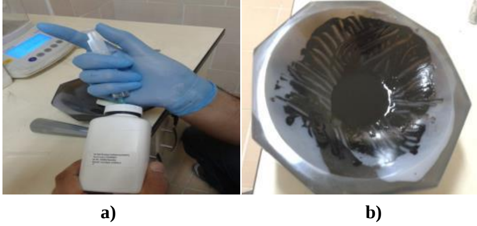
Şekil 2.4. a) Sıvı NMP'nin ölçülü enjektöre alınması b) çözücünün karışıma eklendikten sonra oluşturulan çamur karışım.
