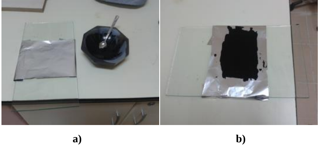
Şekil 2.5. a) Çamur halindeki karışımın üzerine serileceği alüminyum folyo ve b) çamur karışımın folyo üzerine serilmiş hali.
