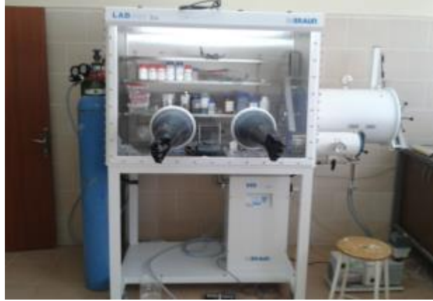
Şekil 2.8. Pil çalışması sırasında kullanılan argon atmosferine sahip glove-box sistemi.
