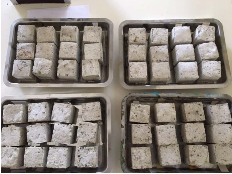
Şekil 3.10. 50x50x50 mm 3 boyutlarında üretilen geopolimer beton numuneler
