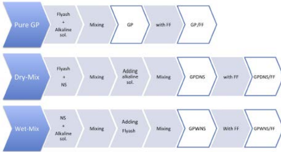
Şekil 2.7. Nano silikanın karıştırılma metotları , (Assaedi vd., 2016b)
