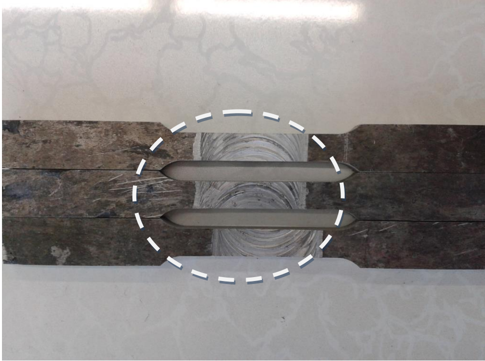
Şekil 3.7. Mikroyapı incelemeleri için ara parçaları alınmış çekme numuneleri
