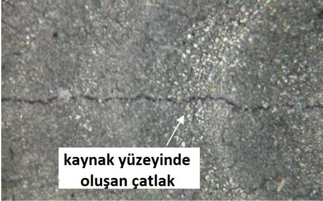
Şekil 2.6. Gaz Tungsten Ark Kaynağı kullanarak 7039 alüminyum alaşımının kaynağında oluşan çatlaklar [19]
