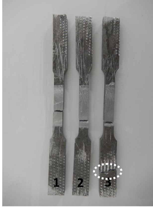
Şekil 4.10. 7039 Al çekme numunelerinin testten sonraki görünüşleri
