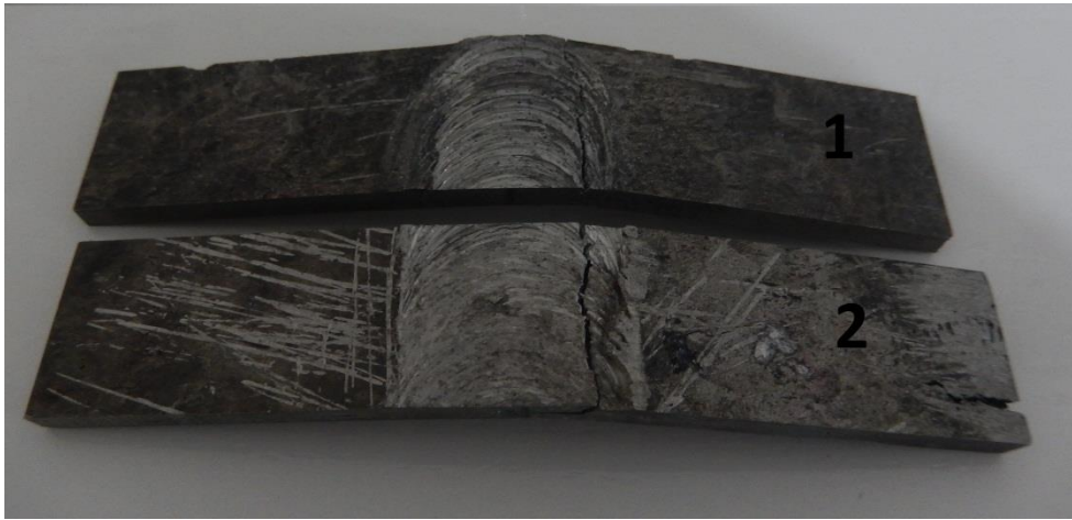
Şekil 4.13. 7039/SiC/10p Eğme testi sonrası görünüm
