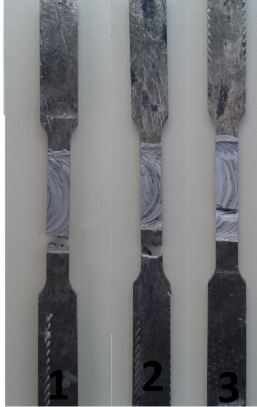
Şekil 4.11. 7039/SiC/10p çekme numunelerinin testten sonraki görünüşleri
