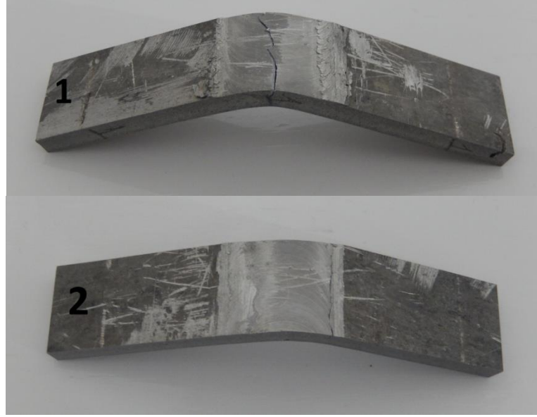
Şekil 4.12. 7039 Al eğme testi sonrası görünüm
