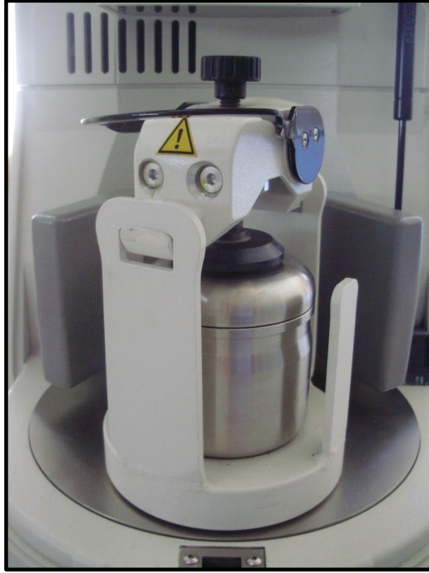
Şekil 3.6. Havanın değirmendeki yatağına yerleştirilmesi
