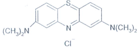
Şekil 2.9. Metilen Mavisi' nin kimyasal yapısı
