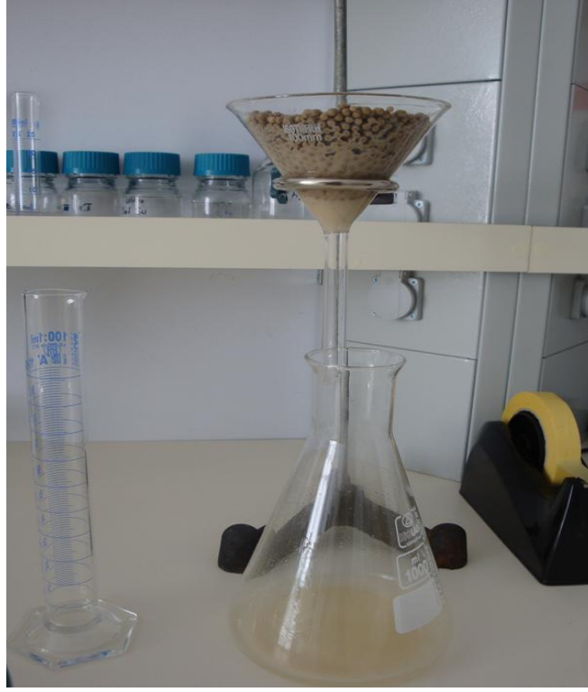
Şekil 3.3. Su içeriği azaltılmış fuzel yağının moleküler elekten ayrımı
