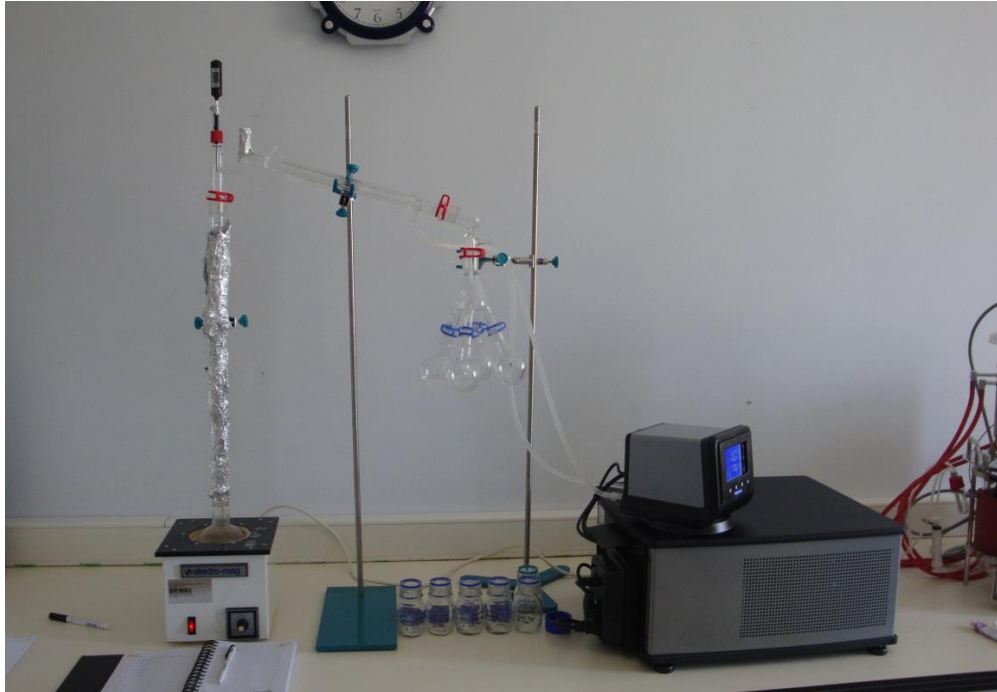
Şekil 3.4. Fuzel yağının damıtılmasında kullanılan damıtma düzeneği
