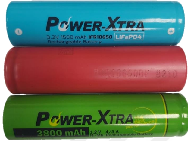
Şekil 4.3: PKB Algoritması Ver.1 deneysel çalışmada kullanılan piller. (Mavi: LFP; Kırmızı: NCA; Yeşil: NiMh)
