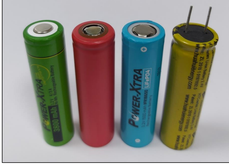
Şekil 4.11: PKB Algoritması Ver.3 çalışmasında kullanılan fiziksel piller (Yeşil: NiMH; Kırmızı: NCA; Mavi: LFP; Sarı:LTO).
