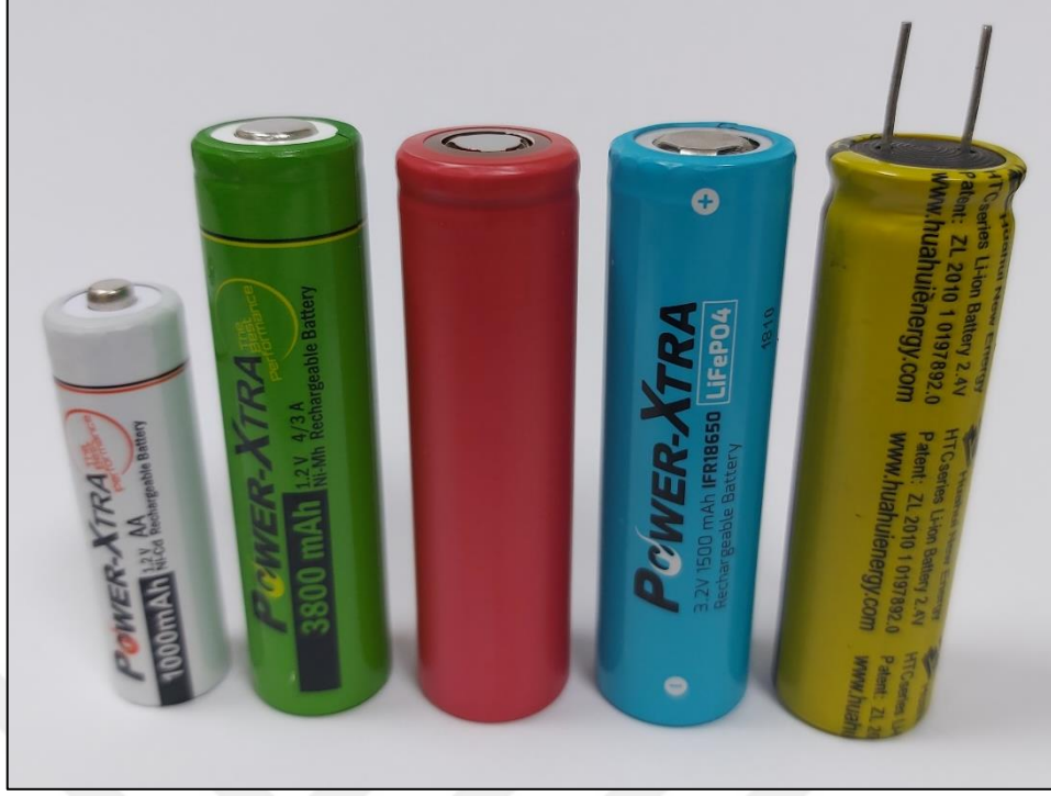
Şekil 3.7: Çalışmada kullanılan piller. (Beyaz: NiCd; Yeşil: NiMH; Kırmızı: NCA; Mavi: LFP; Sarı: LTO).
