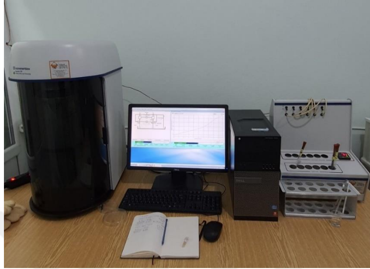
Şekil 3.17 : Micromeritics Gemini VII 2390 model BET cihazı ve Degas ünitesi.
