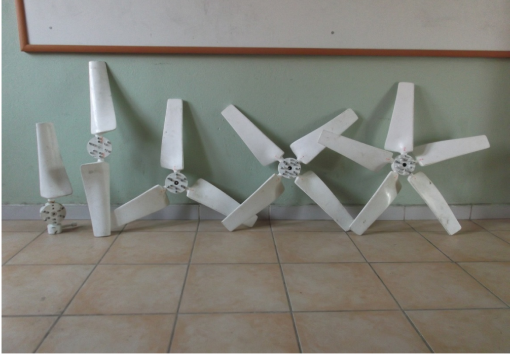
Şekil 3.24 Güneş bacası sisteminde kullanılan türbinler ( r = 0.4 m)
