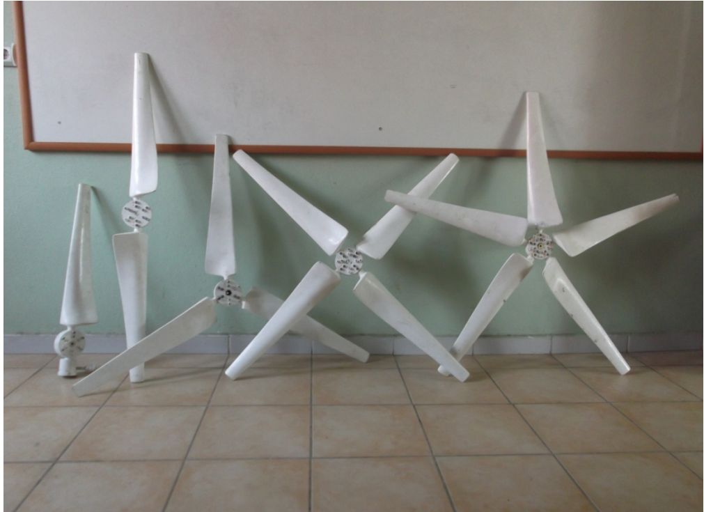
Şekil 3.25 Güneş bacası sisteminde kullanılan türbinler ( r = 0.6 m)
