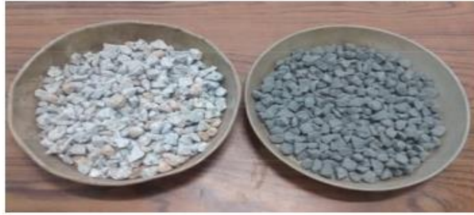
Şekil 3.38 : Katkısız agrega ve geopolimerle çevrenmiş agrega.
