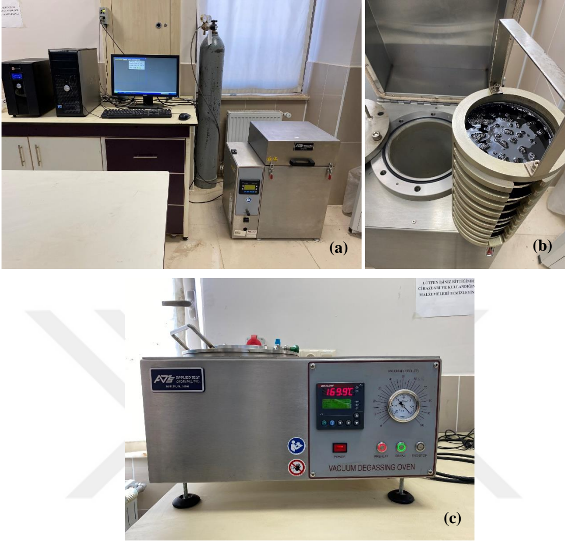
Şekil 2.22 : (a) PAV deney seti (b) deney sonrası bağlayıcıda bulunan hava kabarcıkları (c) vakumlu etüv cihazı.
