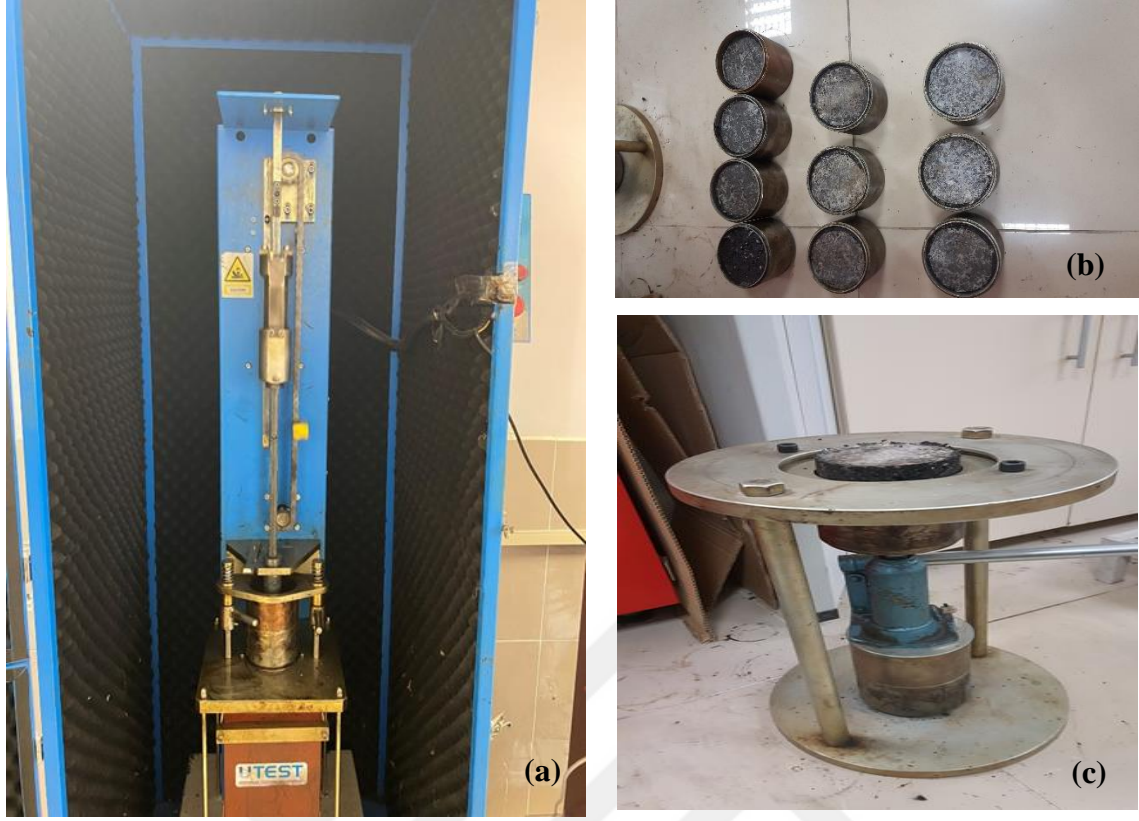
Şekil 5.85 : (a) Numunenin Marshall tokmağında sıkıştırılması (b) kalıpta bekletilmesi (c) kriko ile kalıptan çıkarılması.
