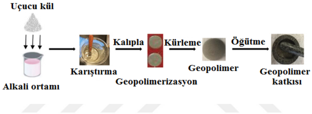
Şekil 3.27 : Geopolimer malzeme hazırlama süreci.
