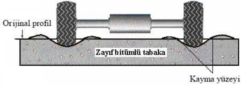
Şekil 2.38 : Plastik deformasyon sebebiyle tekerlek izi oluşumu.
