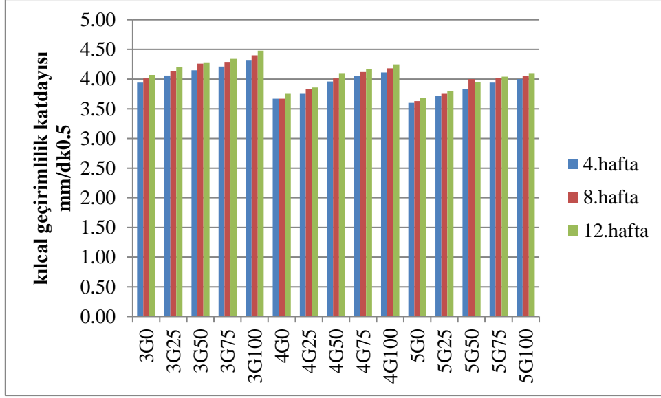
Şekil 4.14. % 1.5MgSO 4 + % 1.5Na 2 SO 4 çözeltilde bekletilen numunelerin kılcal geçirimsizlik katsayısı
