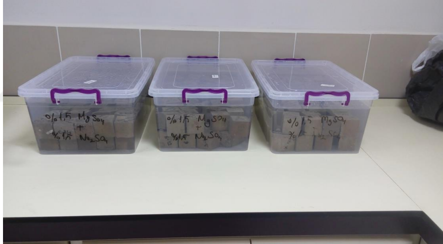
Şekil 3. 20. Sülfat çözeltisinde bekletilen numuneler
