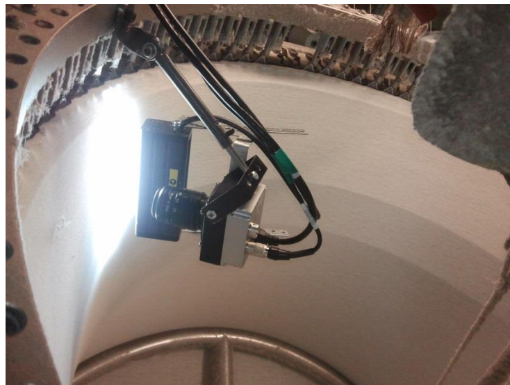
Şekil 7.3. Gerçek zamanlı hata tespiti için yuvarlak örgü makinesi içerisine kurulan görüntü elde etme sistemi
