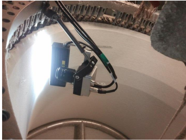
Şekil 5.7. Yuvarlak örgü makinesi üzerine kurulan görüntü kayıt sistemi
