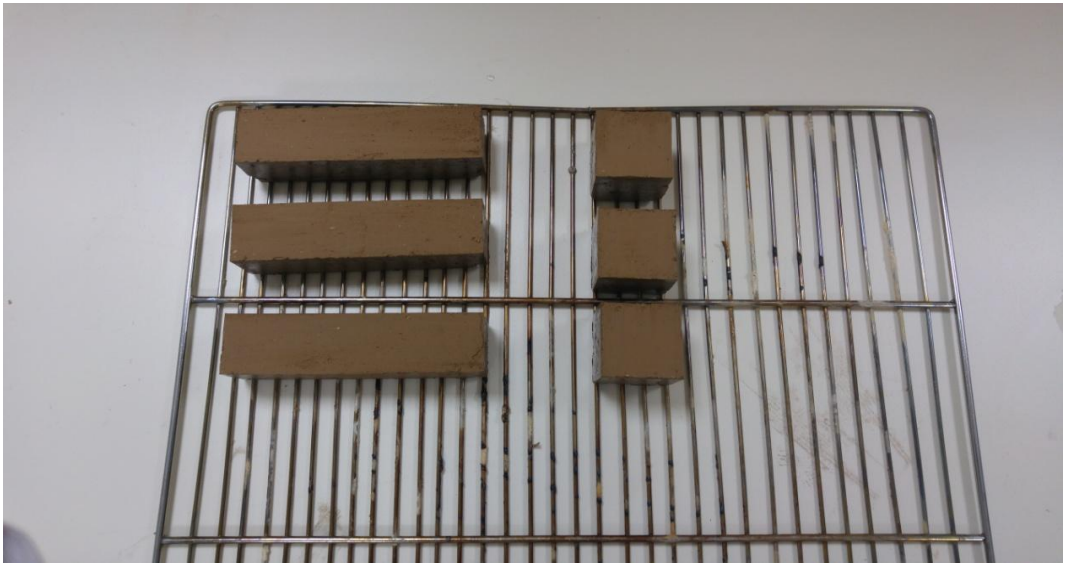
Şekil 4.11. Kalıptan çıkarılmış tuğla numuneleri
