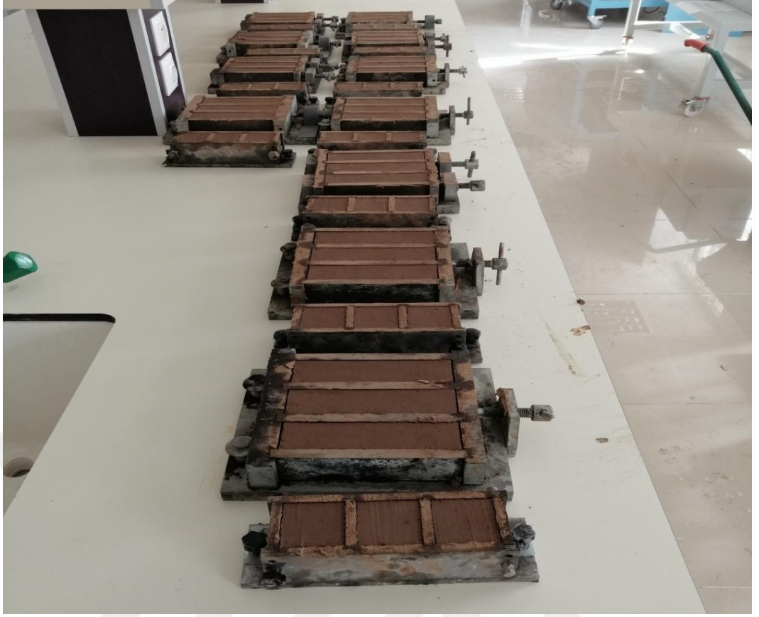
Şekil 4.10. Kalıplara yerleştirilmiş tuğla numuneleri
