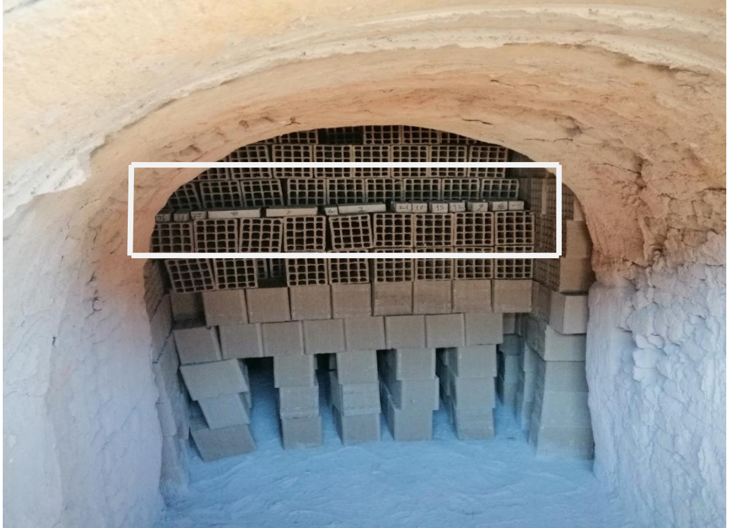
Şekil 4.13. Pişirme işlemi uygulanacak tuğlaların fırına yerleştirilmesi
