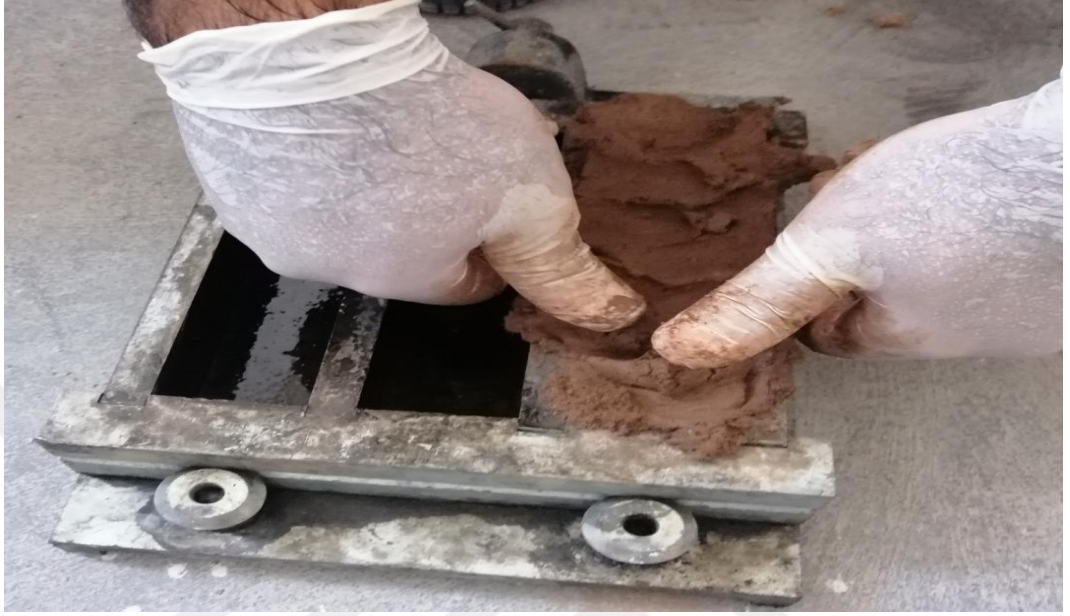
Şekil 4.9. Kalıplara karışımların yerleştirilmesi
