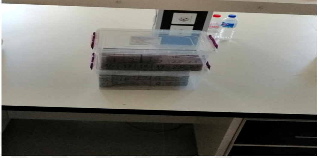
Şekil 4.12. Kaplara yerleştirilen tuğla numuneleri
