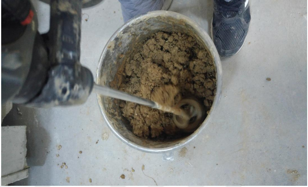
Şekil 4.5. Killi toprak ile KCE'nin veya PP'nin karıştırılması
