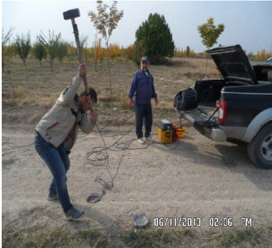
Şekil 3.9 Çalışma alanında sismik kırılma Masw çalışması
