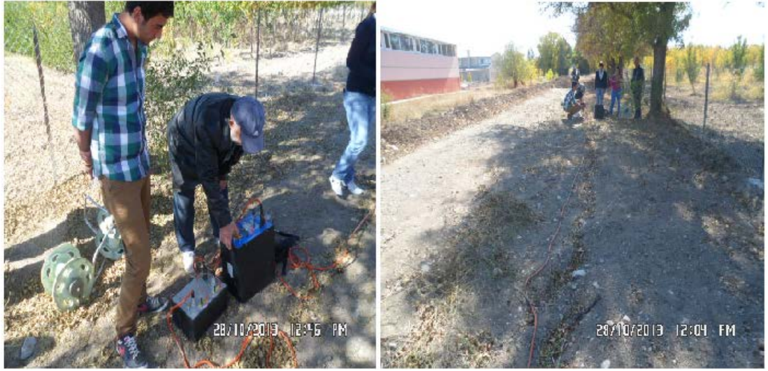
Şekil 3.12. Çalışma alanında çok kanallı DES arazi ölçümü
