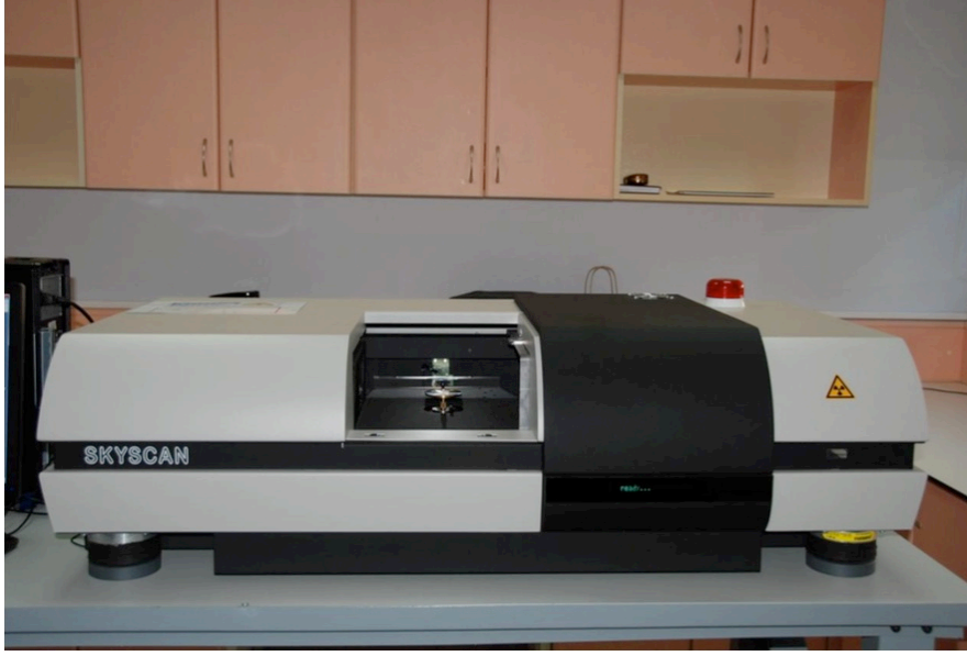
Şekil 3.29 Mikro Bilgisayarlı Tomografi (Mikro-BT) cihazı.
