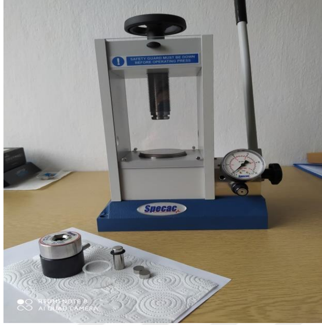
Şekil 3.1: Maksimum 25 ton kapasiteli presleme ve peletleme sistemi.
