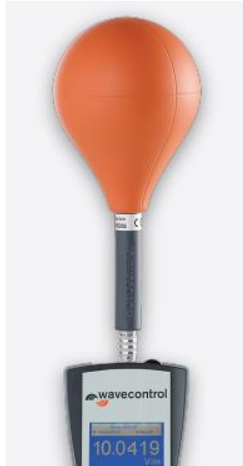
Şekil 3.16. 10Hz-3kHz frekans bandında ölçüm alan alçak frekans probunun genel görünümü
