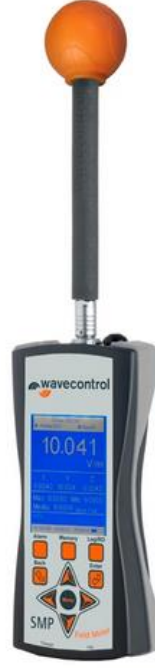
Şekil 3.17. SMP EMF Metre'nin 100kHz-8GHz probu ile genel görünümü
