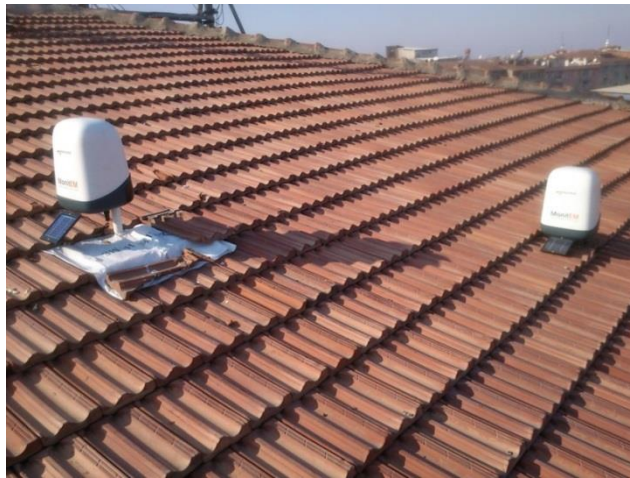
Şekil 4.50. Şehir merkezine konumlandırılmış iki MonitEM sürekli elektrik alanları ölçüm ve izleme istasyonu
