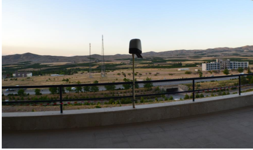
Şekil 4.57. Turgut Özal Tıp Merkezi 1. katında hastanenin kuzey bölgelerindeki baz istasyonlarının görüş açısında yerleştirilmiş olan istasyonun genel görünümü
