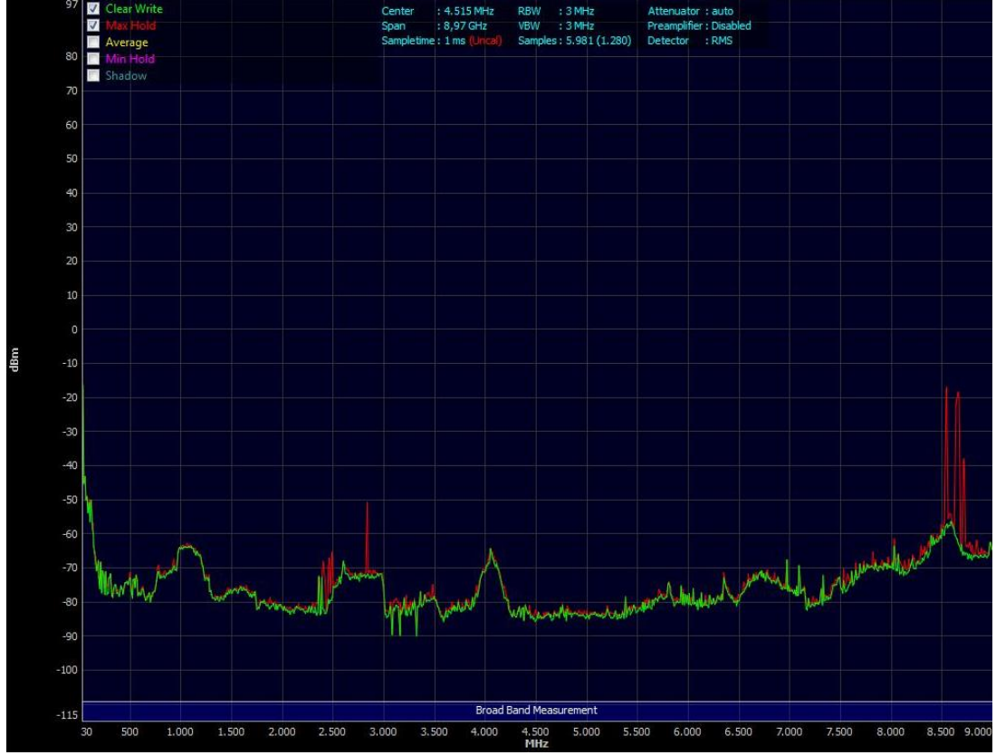
Şekil 4.36. Hastane içerisinde elektrik alan kaynaklarını ve frekans değerlerini belirlemek amacıyla yapılmış olan spektrum analizi.
