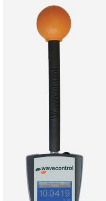
Şekil 3.15. 100kHz-8GHz frekans bandında ölçüm alan geniş band probunun genel görünümü
