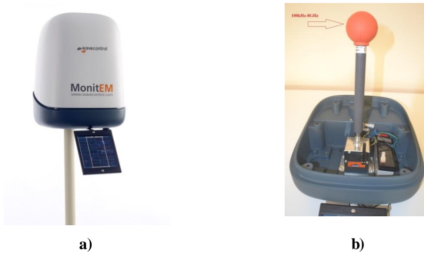
Şekil 3.1. Elektromanyetik alan sürekli ölçüm sistemi MonitEM a- MonitEM’in genel görünümü, b- MonitEM’in ölçüm donanımları
