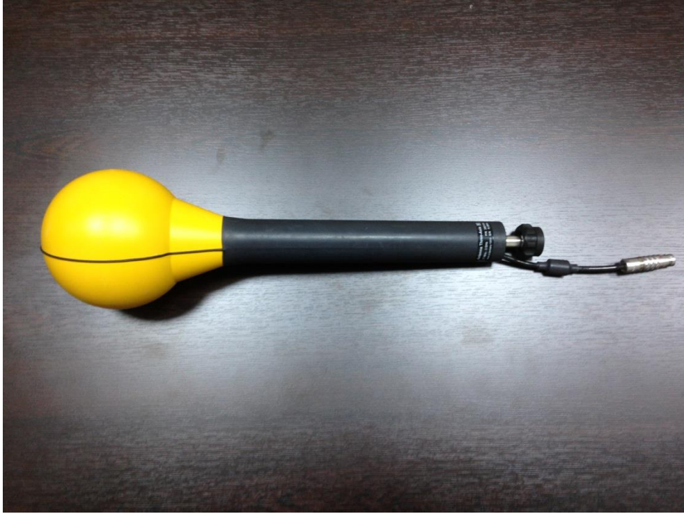
Şekil 3.2. Üç eksenli elektrik alan anteni
