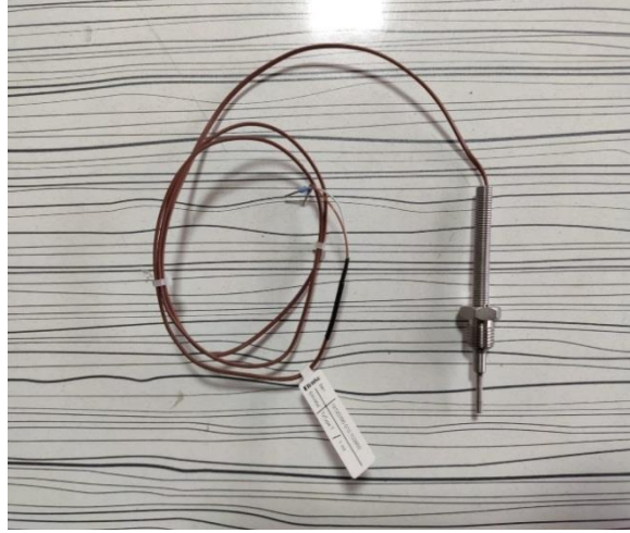
Şekil 3.12 : Deney setinde kullanılan termokupl
