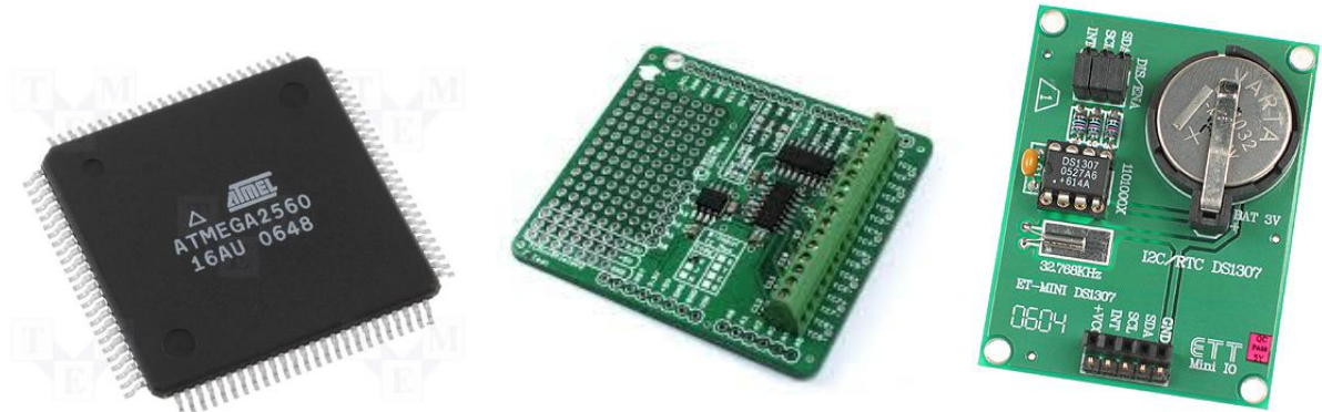
Şekil 2. (a) ATmega2560 mikro işlemci, (b) KTA-259v4 ve DS1307 saat devresi [6-8]
