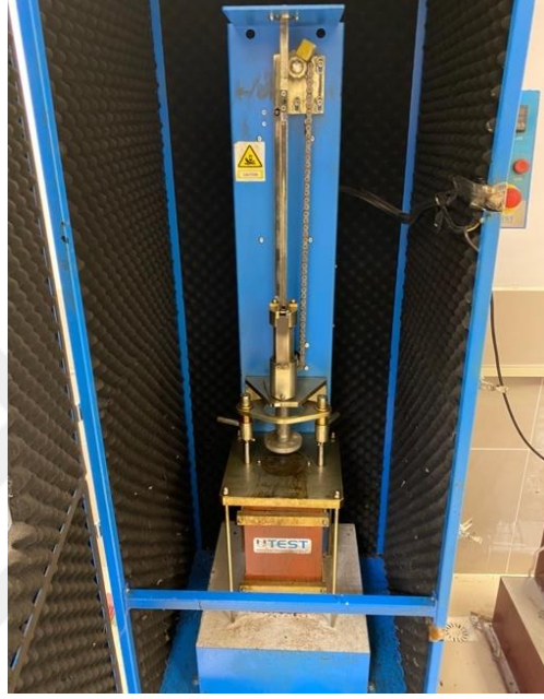
Şekil 4.49: Numunelerin sıkıştırılmasında kullanılan Marshall Tokmağı
