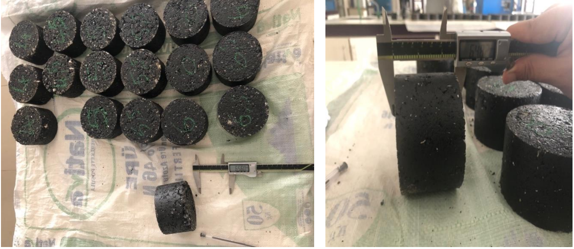
Şekil 4.50: Hazırlanan karışım numuneleri ve kumpas ile yüksekliklerinin belirlenmesi
