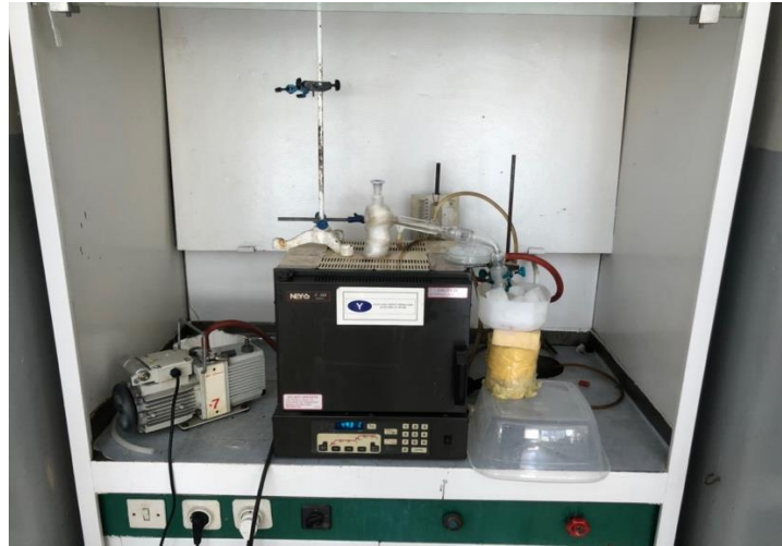
Şekil 4.1: MMA Monomeri Hazırlamak İçin Kurulan Deney Düzeneği
