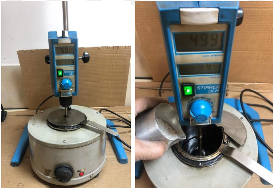
Şekil 4.9: Karıştırma Cihazı ve Kopolimerin Bitüme Eklenmesi
