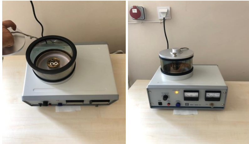
Şekil 4.31: Bağlayıcıların altın tozu ile kaplanması ve SEM cihazı
