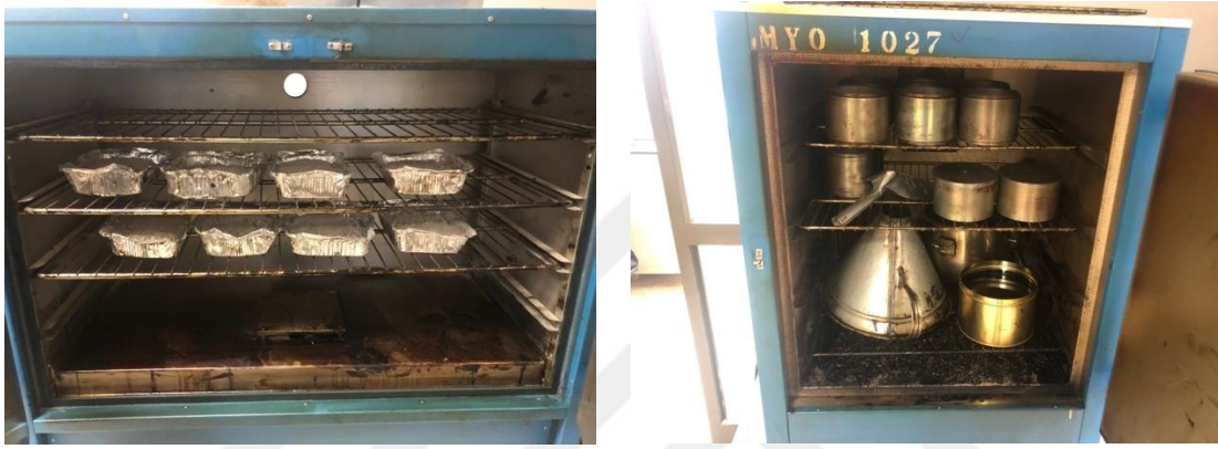
Şekil 4.47: Agregaların Etüvde Isıtılması ve Kalıplar ile Bitümün Isıtılması
