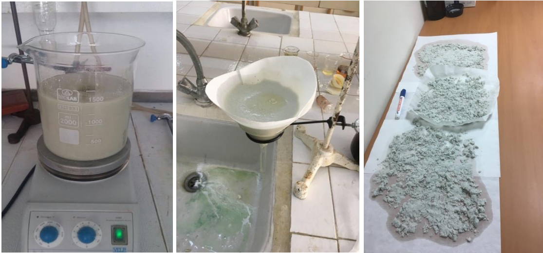
Şekil 4.5: Hazırlanan Graft Kopolimerin Çöktürme – Süzülme ve Kurutulması
