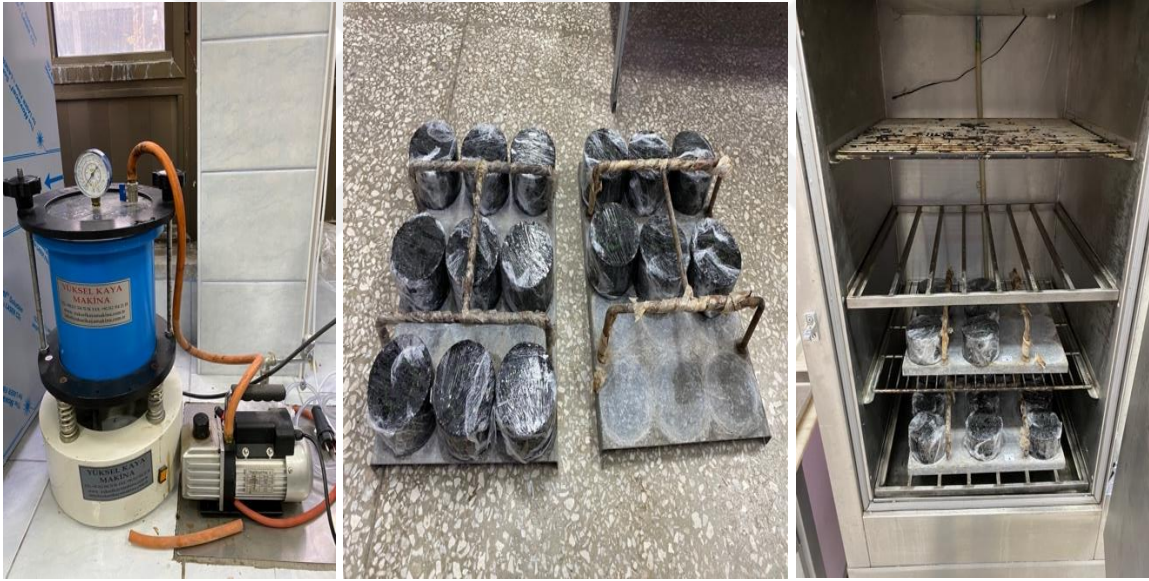
Şekil 4.64: Vakum Cihazı, Numunelerin Streç Filmle Sarılması ve Dondurucuda Bekletilmesi
