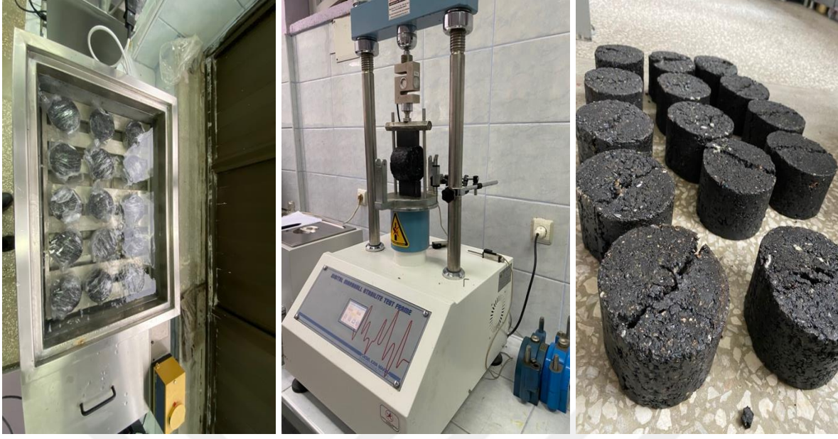
Şekil 4.65: Su Banyosunda Bekletilen Numuneler, ITS Deneyi ve Kırılan Numuneler
