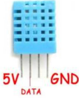
Şekil 4.4: DHT11 Kartının Devre Bağlantısı Görseli
