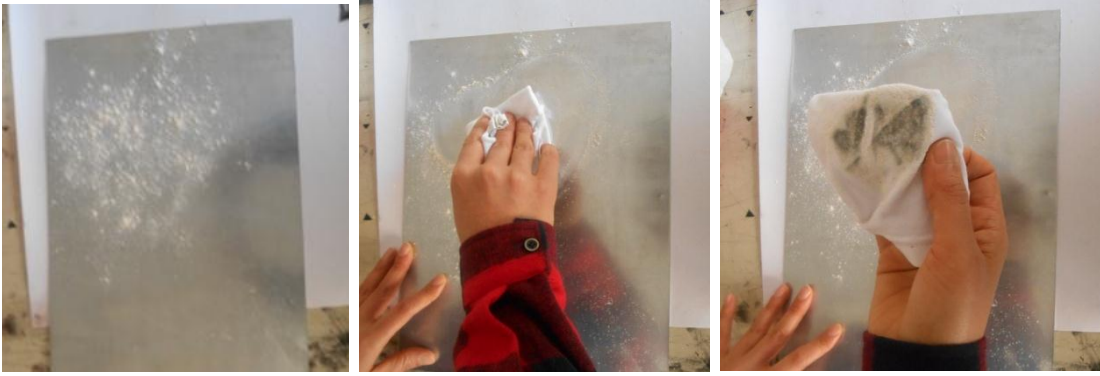
Resim 27. Çinko Levhanın Üstübeç ile Temizlenmesi.
