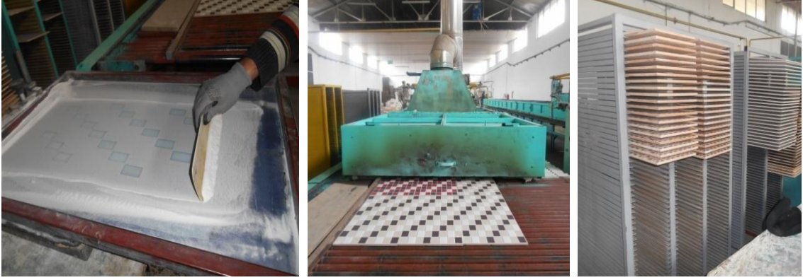
Resim 46. Cam Tozunun Elekten Seramiğe Aktarılması ve Fırınlanması.
