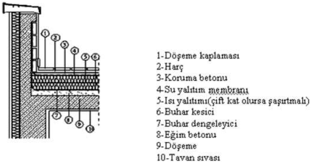
Şekil 2.13.Üzerinde Gezilen Teras Çatılarda Isı Yalıtımı
