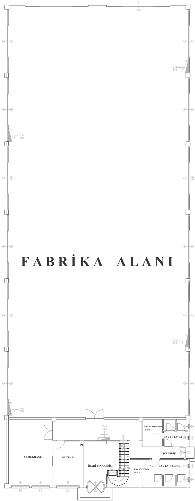
Şekil 4.10. Yangın dolaplarının gösterimi
