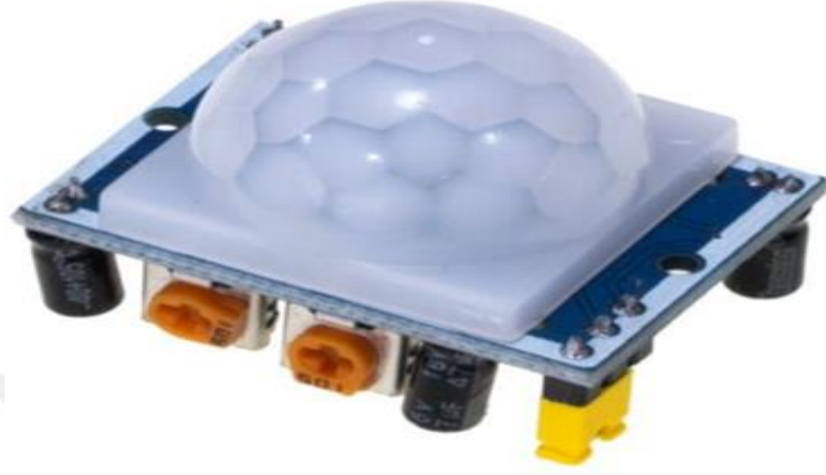
Şekil 3.6. HC-SR501 PIR sensörü
