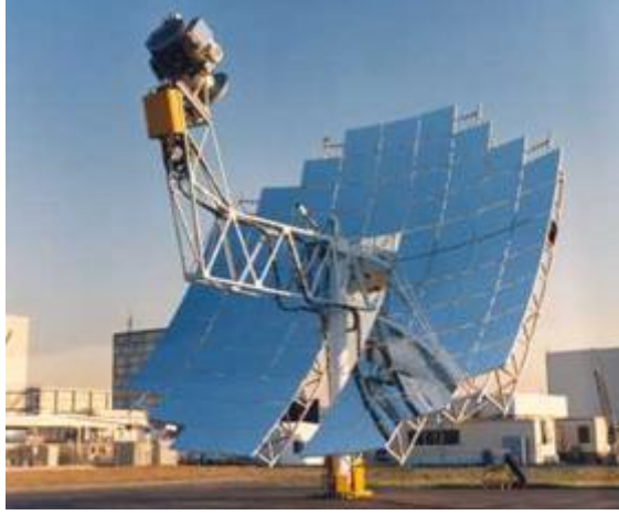
Şekil 1.9 Parabolik çanak güneş kolektörü [13]
