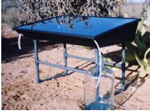
Şekil 1.4 Güneş enerjisiyle tatlı su arıtma sistemi [13]
