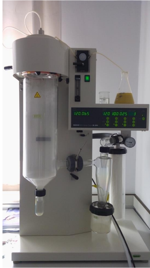
řekil 3.1 : Pskrtmeli kurutma teknięi ile yeřil ay ekstraktının enkapslasyonu.
