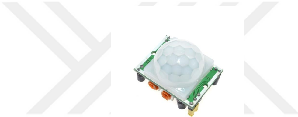
Şekil 4. 8. HC-SR501 hareket algılama sensörü (PIR dedektör)
