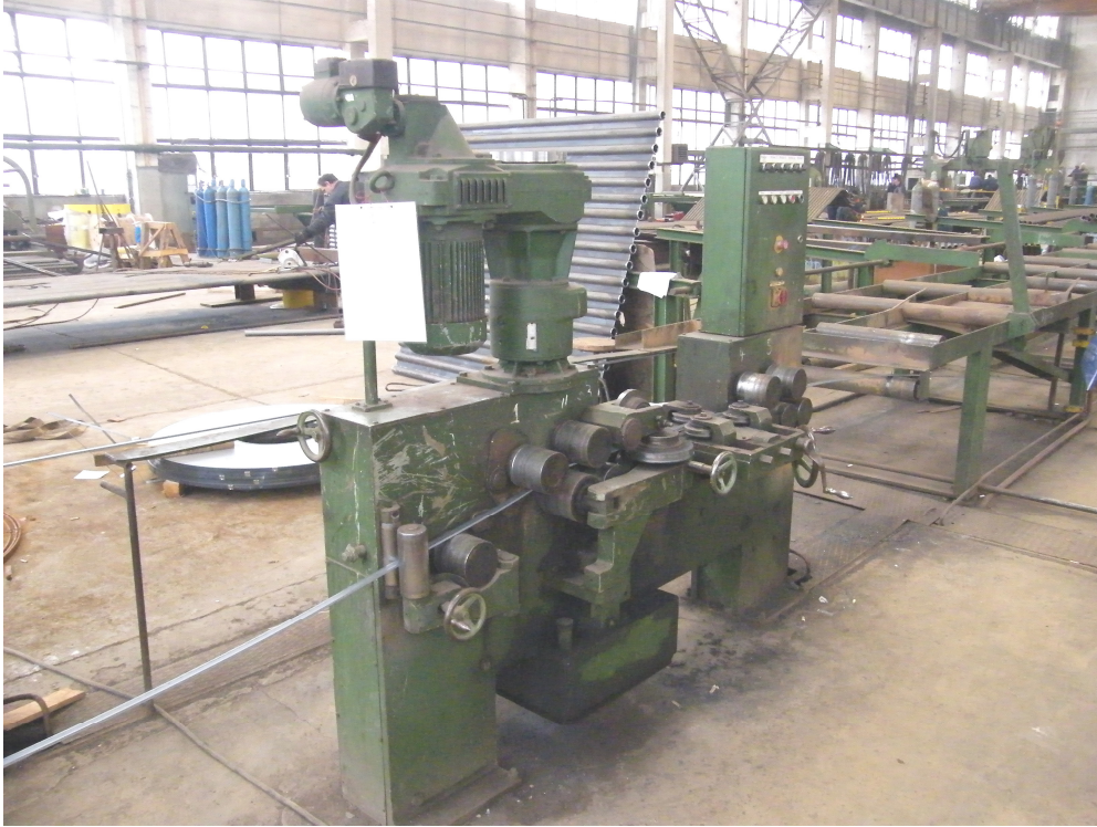
Şekil 6. Lama düzeltme makinesinin sonsuz beslemesi
