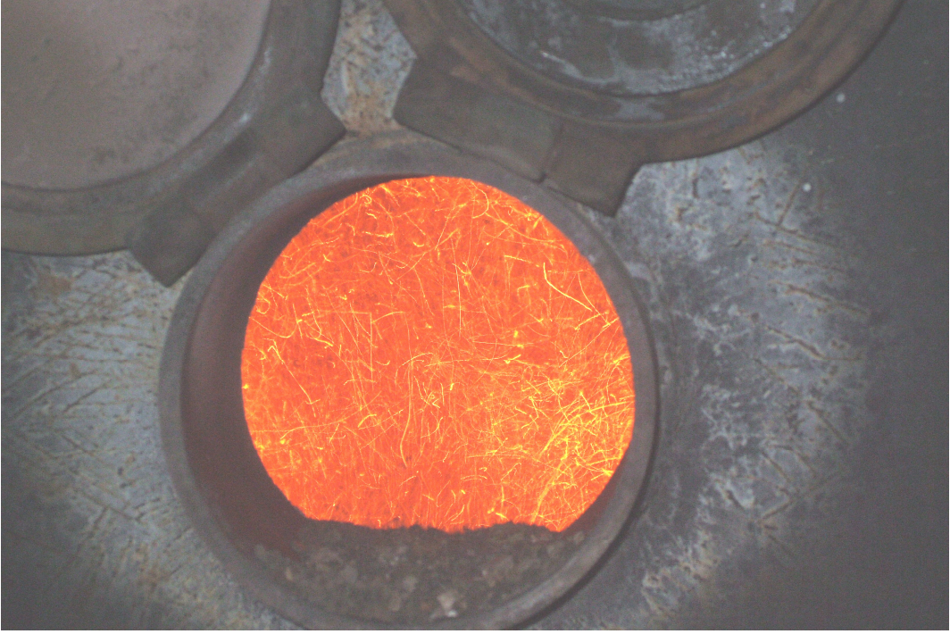
Şekil 15. Toz kömürünün akışkan yataklı kazanda yanması
