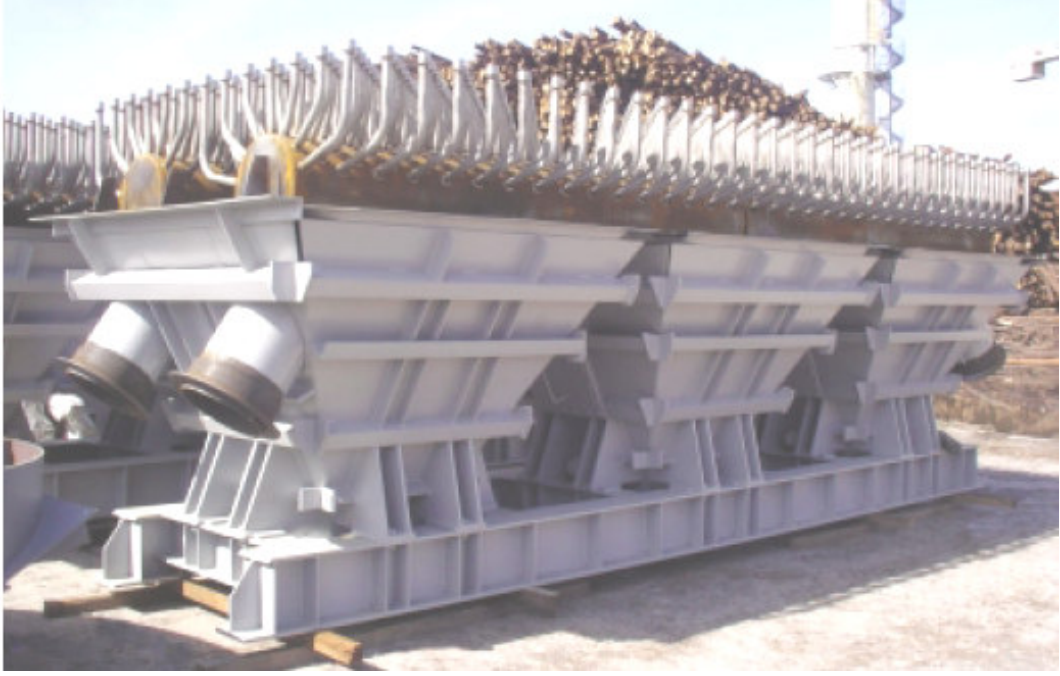
Şekil 14. Yatak bölümü hava sirkülasyonu ile toz kömürüne yataklama yapar.
