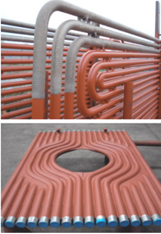
Şekil 1: Su borulu kazanın brülör kaidesi
