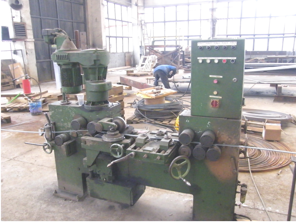
Şekil 5. Lama düzeltme ve kaynak ağız açma makinesi
