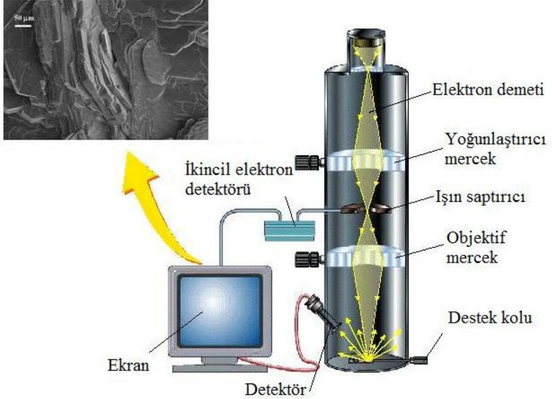
Şekil 2.49. Bir Taramalı Elektron Mikroskopisinin şematik gösterimi.
