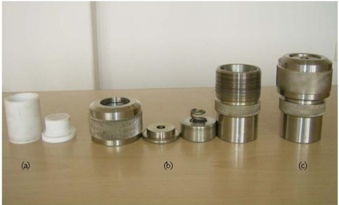
Şekil 3.1 (a) Teflon reaksiyon kabı ve kapağı (b) Basınca dayanıklı asit sindirme kabı ve parçaları (c) Deneye hazır, kapalı reaksiyon kabı.
