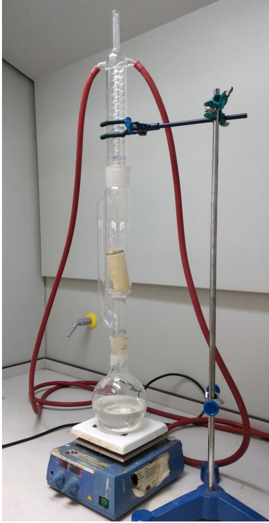
Şekil 3.11 Soxhlet ekstraksiyon düzeneği
