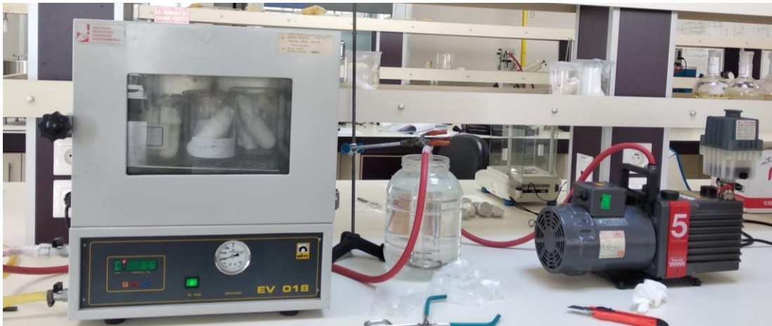
Şekil 3.2 Vakum etüvü (örneklerin kurutulması) sistemi
