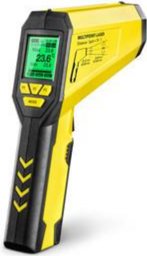
Şekil 3.9 Trotec TP10 lazer pirometre
