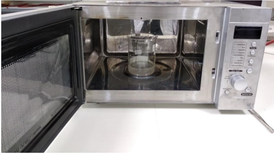
Şekil 3.7 Mikrodalga deney düzeneği
