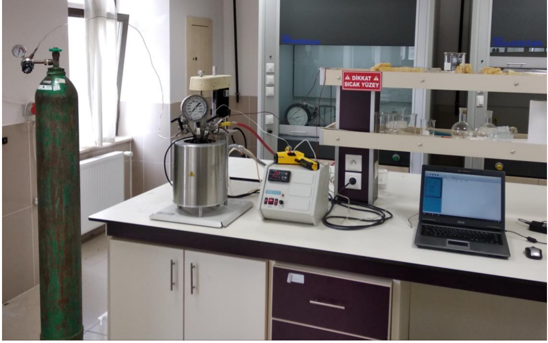
Şekil 3.4 Deneyde kullanılan kesikli reaktör sistemi
