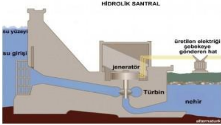
Şekil 3.3 Hidroelektrik Santrali Şeması
