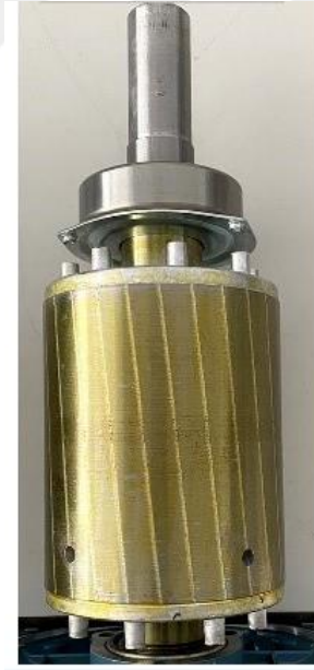
Şekil 4.11: Tam kutup aralıklı kırık iki rotor çubuğu
