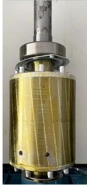
Şekil 4.8: Yarım kutup aralıklı kırılmış rotor çubukları
