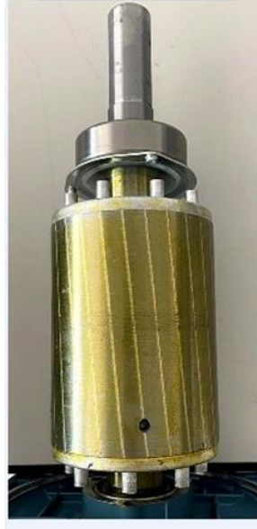
Şekil 2.1 : Bir kırık rotor çubuğu arızasının görünümü.
