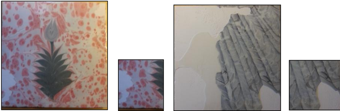
Şekil 3.12. Sır denemeleri esnasında meydana gelen uyumsuzluklar
