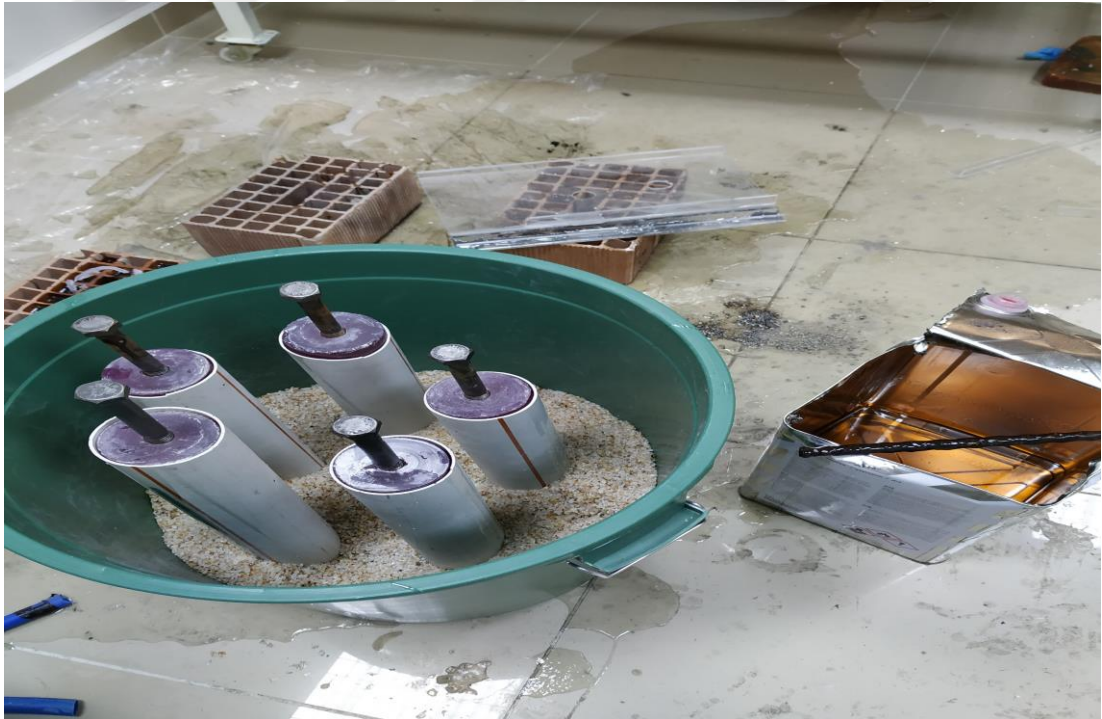
Şekil 5.4 Polyester malzeme ile venturi üretimi
