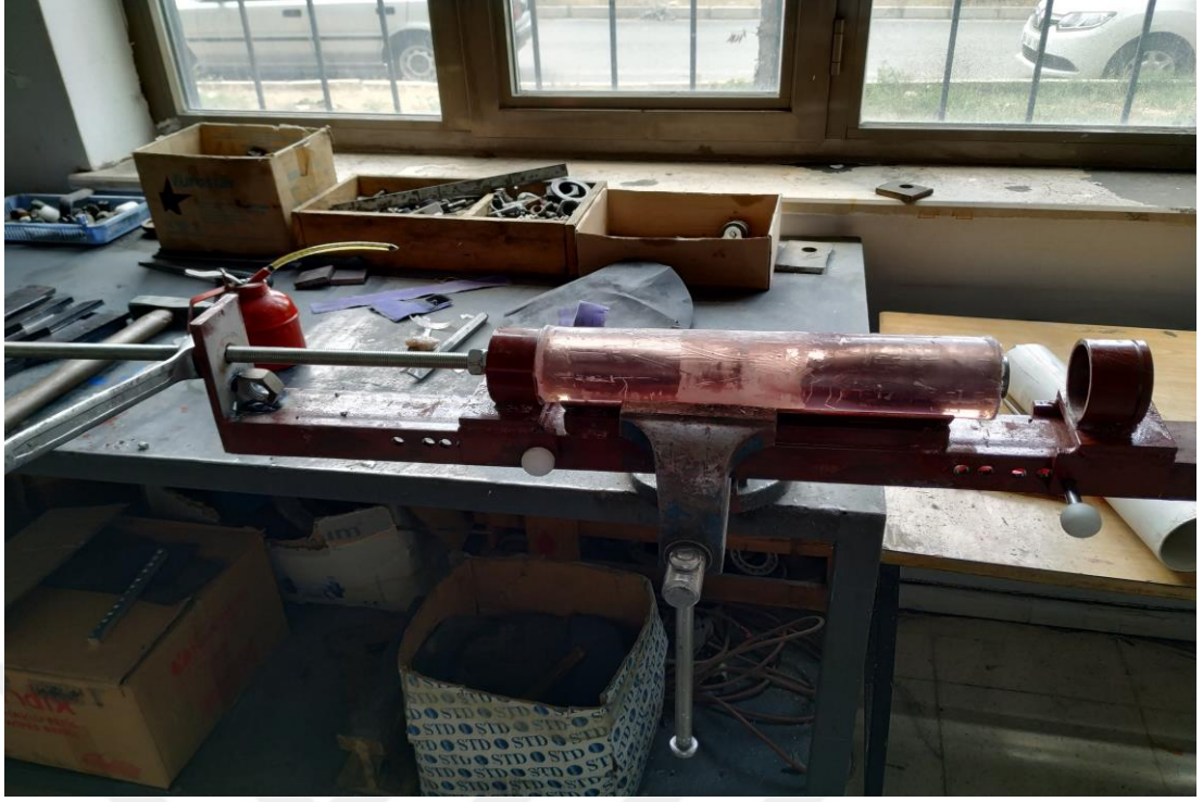
Şekil 5.5 İç kalıbın sökülmesi
