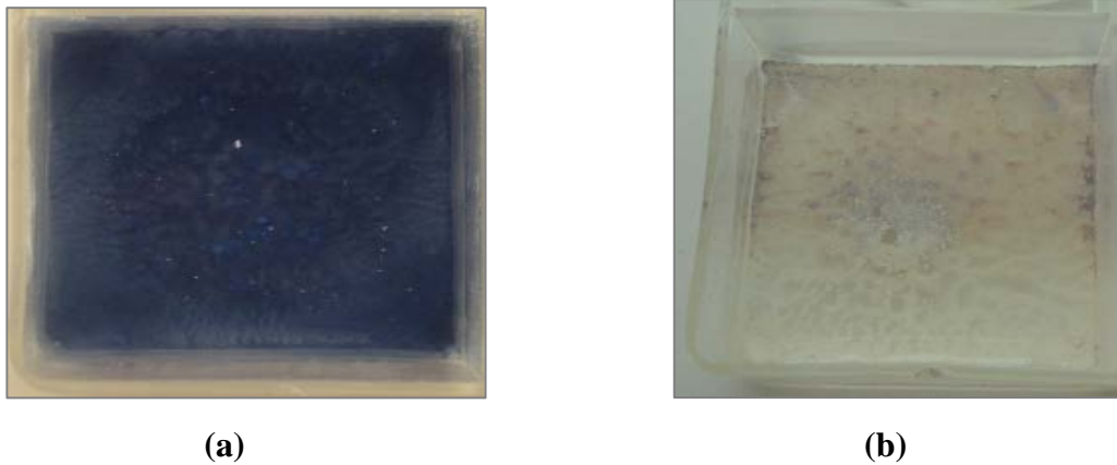
Şekil 4.11. a) Işılama öncesi, b) 60 dk fotokatalitik parçalanma sonrası RB 5 çözeltilerinin görüntüsü
