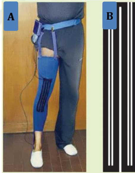
Şekil 3.10 : A’da yürüyüş analizi için tasarlanan bir diz bandının uygulanaşı, B’de ise diz bandının görseli bulunmaktadır [62].
