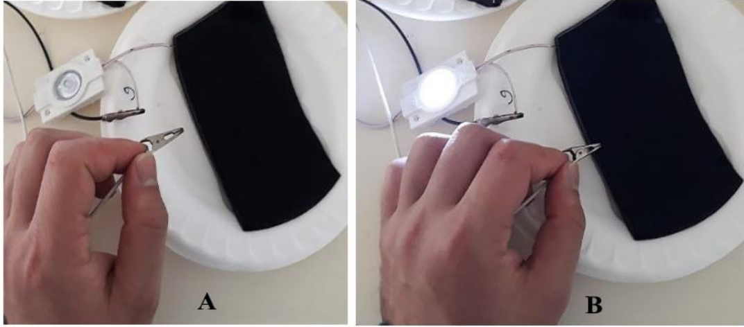
Şekil 6.1 : \text{SO}_5 hidrojelinin led ışık yanmasında kullanılması (A: devre açık iken, B: devre kapalı iken fotoğrafları)
