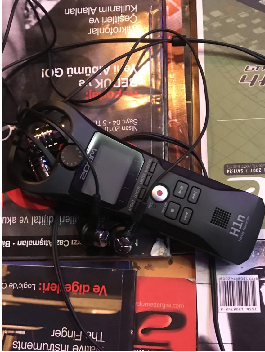
Şekil 13.16. Binaural Kayıt İçin Kullanılan Roland cs 10em Binaural mikrofon ve zoom h1n ses kaydedicisi
