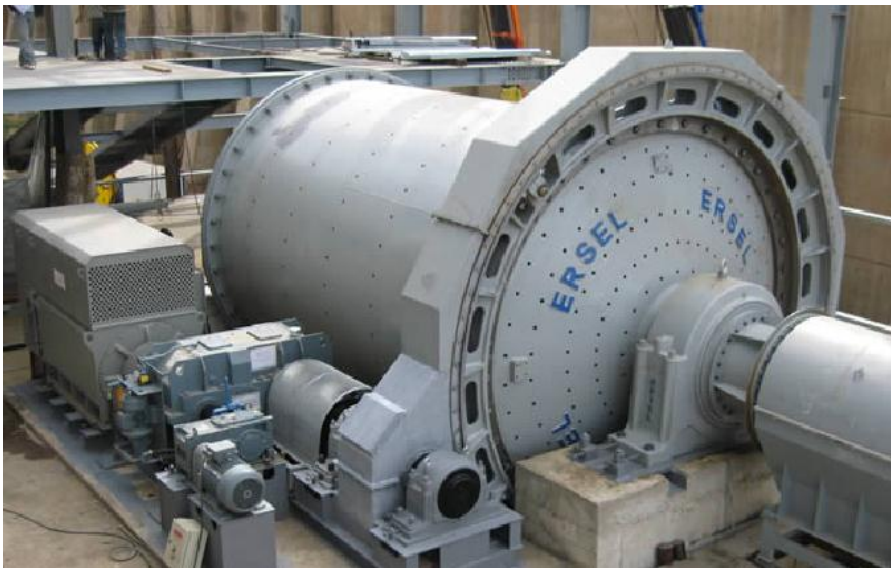
Şekil 3.8. Sanayide kullanılan bilyalı değirmen [23].
