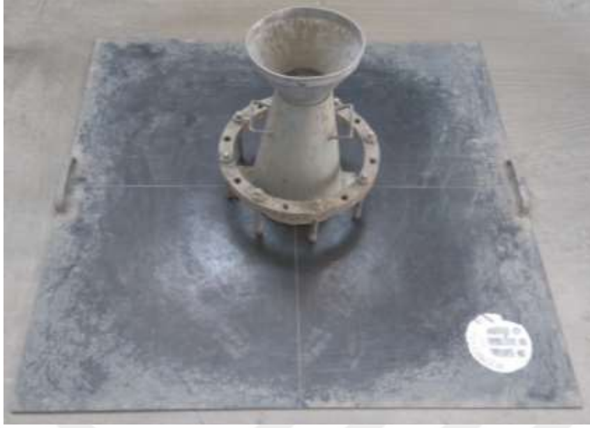
Şekil 3.10 : J-halkalı çökme-yayılma deney düzeneği.
