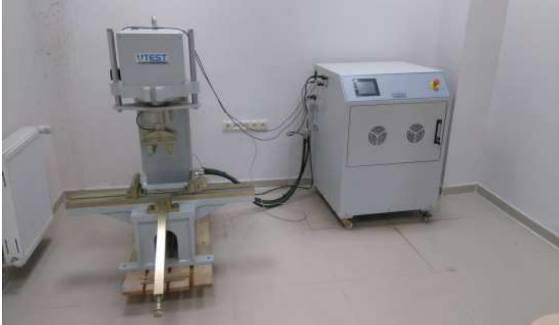
Şekil 3.15 : Dört noktalı eğilmede çekme dayanımı deney ekipmanı.
