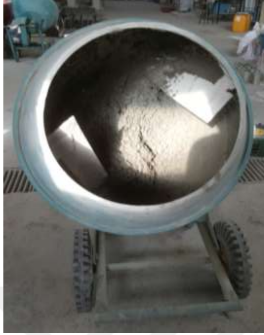
Şekil 3.7 : Karışımların hazırlanmasında kullanılan düşey eksenli mikser.
