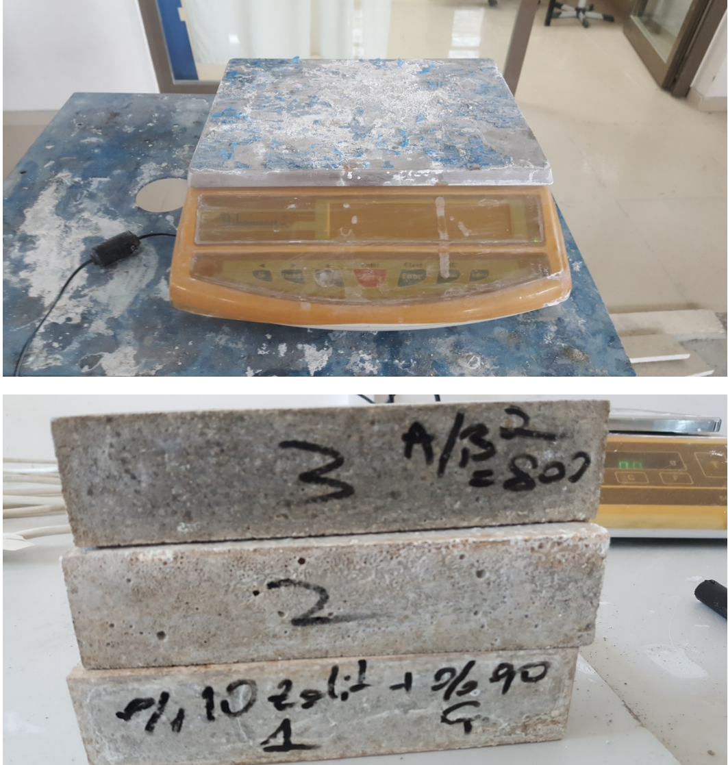
Şekil 4.4. 1g hassasiyetli terazi ve kullanılan bazı numune örnekleri
