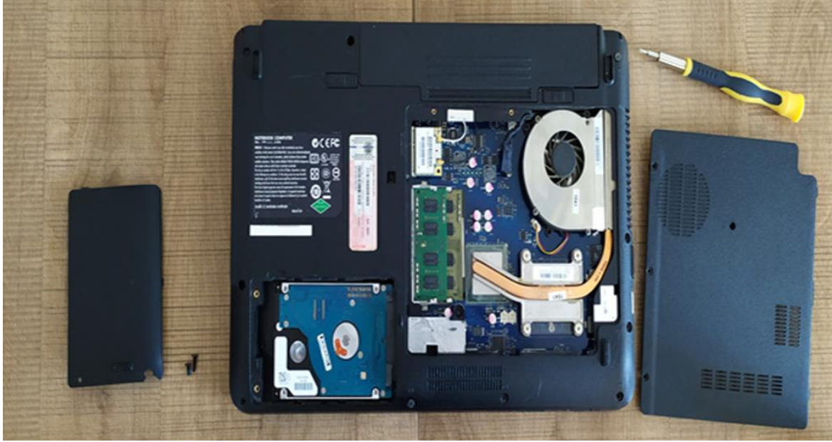
Şekil 4.2 : Laptop arka kapak sökümü.
