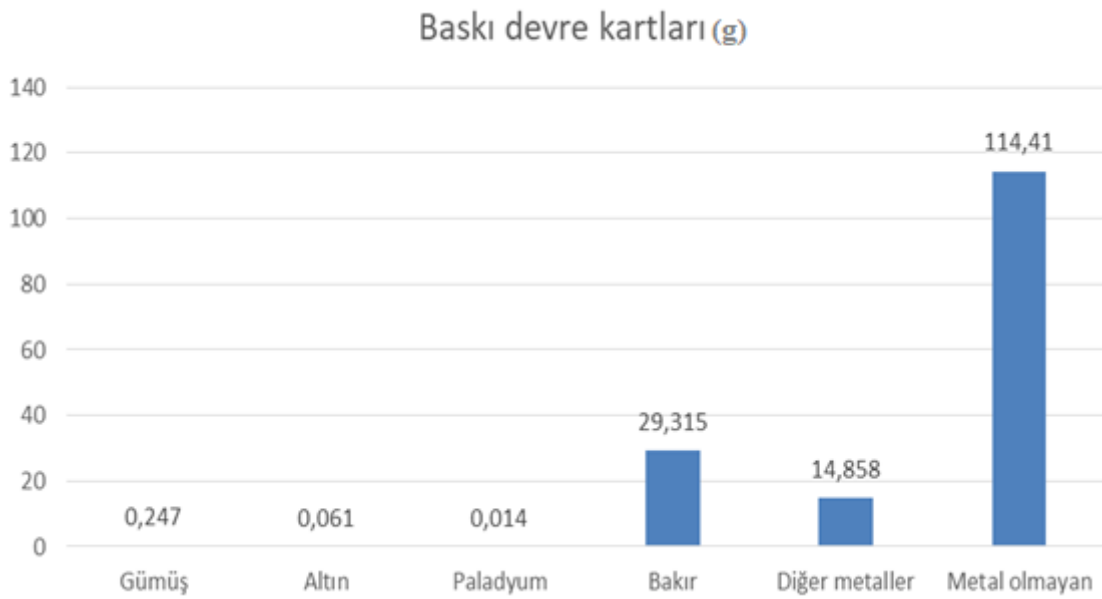
Şekil 5.3 : Sökülen baskılı devre kartında bulunan maddeler.
