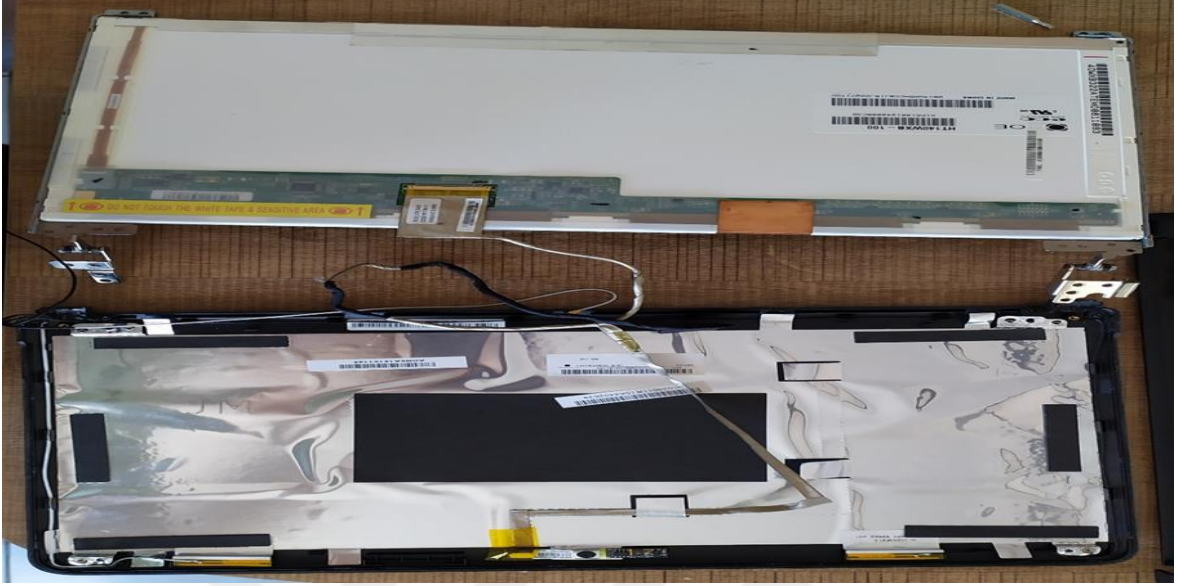
Şekil 4.4 : Ekran ve pvc panel sökümü.
