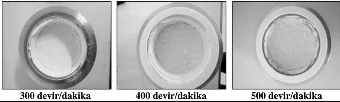
Şekil 4.16. B:C= 10 ve 60 dakika öğütme süresinde 300, 400 ve 500 devir/dakika öğütme sonucu havan görünümü
