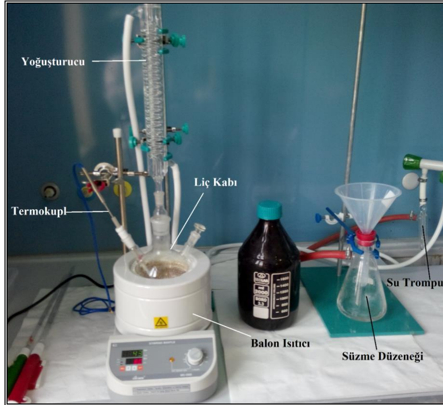
Şekil 3.6. Kesikli liç için kullanılan karıştırıcılı balon ısıtıcı düzeneği (solda) ve vakumlu süzme düzeneği
