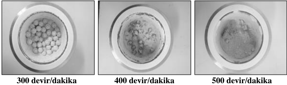
Şekil 4.17. B:C= 20 ve 60 dakika öğütme süresinde 300, 400 ve 500 devir/dakika öğütme sonucu havan görünümü
