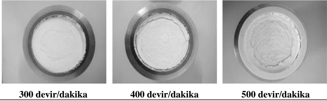
Şekil 4.15. B:C= 5 ve 60 dakika öğütme süresinde 300, 400 ve 500 devir/dakika öğütme sonucu havan görünümü
