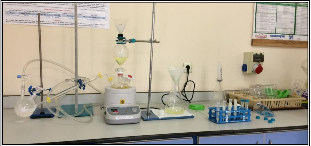
Şekil 3.8. Yüklü liç çözeltisinden AlCl_3 çöktürülmesi için hazırlanan (a) evaporasyon düzeneği, (b) Balon ısıtıcıda liç kabı, (c) Su soğutmalı yoğuşturucu, (d) Evaporasyon işlemi
